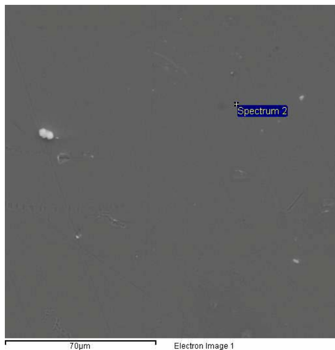
Slika 21. SEM snimka mikrostrukture površine sol-gel TiO 2 prevlake s tri sloja dobivene uranjanjem u sol 2.
