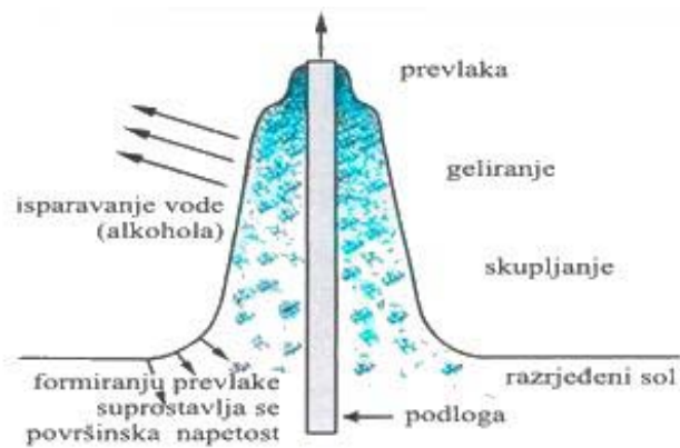
Slika 5. Prikaz procesa geliranja isparavanjem otapala i destabilizacijom sola [1].
