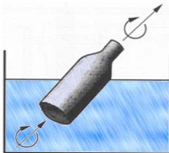
Slika 8. Pojednostavljeni prikaz uranjanja i okretanja [1].
