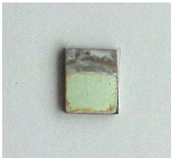
Slika 19. Čelična pločica sa sol-gel \text{TiO}_2 prevlakom nakon postupka uranjanja, sušenja i kalciniranja.
