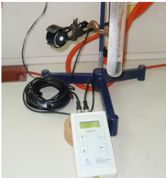
Slika 10. UV VIS Radiometer RM 21 i pripadajući osjetnik UV RMC tvrtke Dr. Gröbel UV-Elektronik GmbH
