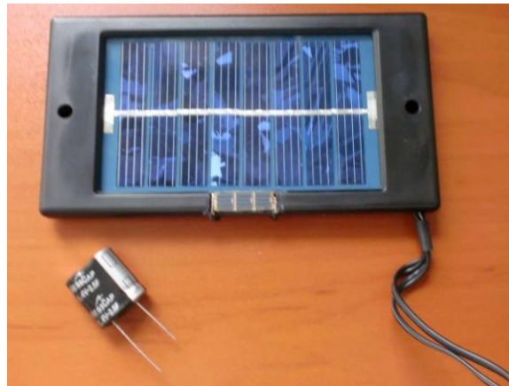
Slika 9: Korišteni solarni panel s pomoćnom solarnom ćelijom. Ispod panela prikazan je superkondenzator
