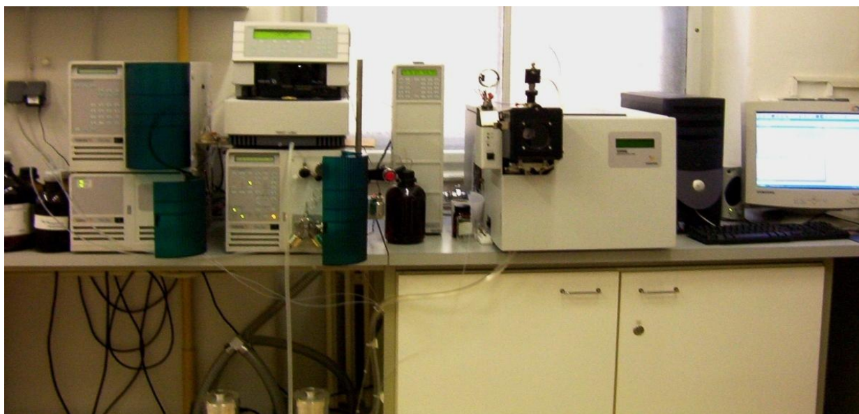
Slika 10. Uređaj za tekućinsku kromatografiju visoke djelotvornosti (Varian ProStar 500) korišten u laboratorijskom radu
