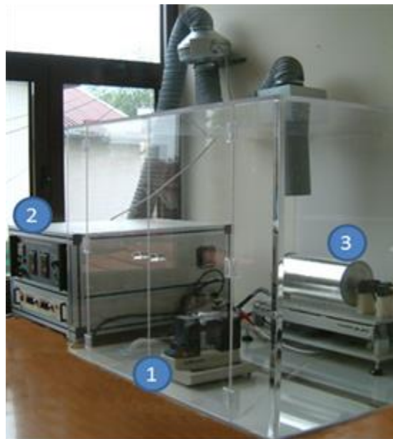
Slika 8. Uređaj za elektroispredanje – Sveučilišta u Zagrebu, Tekstilno-tehnološki fakultet.
