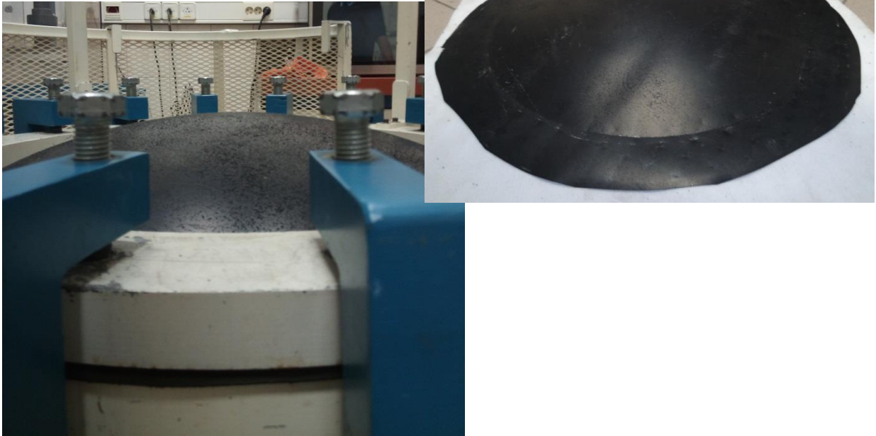
Slika 30. U obliku sfere deformirana geomembrana
