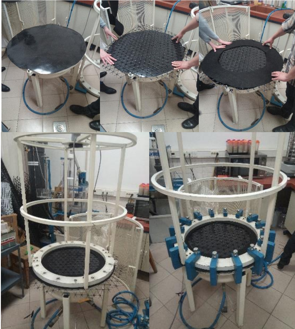
Slika 18. Postavljanje uzorka u uređaj za višeosno vlačno ispitivanje
