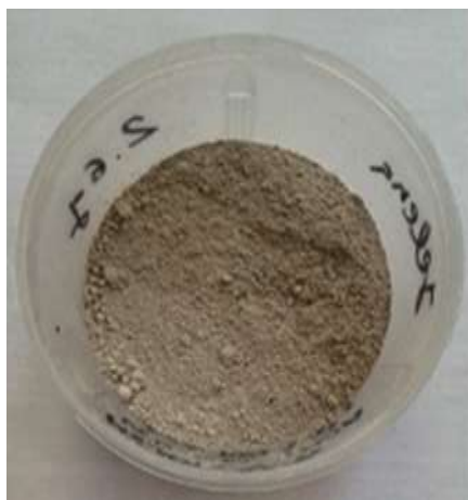
Slika 19. Nanočestice \text{TiO}_2 na bio-predložku membrane ljuske jaja toplinski obrađene na 500\text{ }^\circ\text{C}
