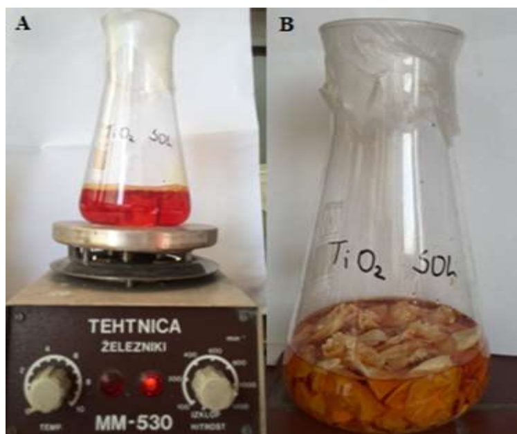
Slika 16. (A) TiO_2 sol, (B) TiO_2 sol + membrane ljuske jaja
