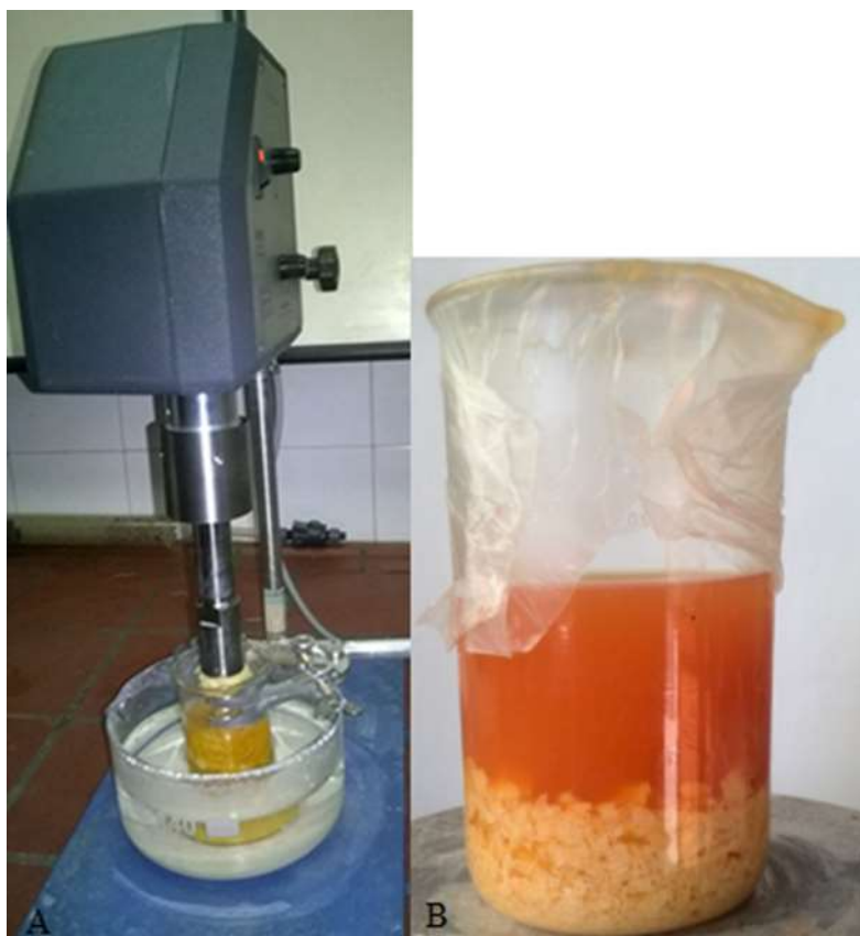
Slika 17. A) Postupak sonokemijskog tretiranja TiO_2 sola + membrane ljuske jaja B) Otopina TiO_2 + membrane ljuske jaja nakon sonokemijskog tretiranja
