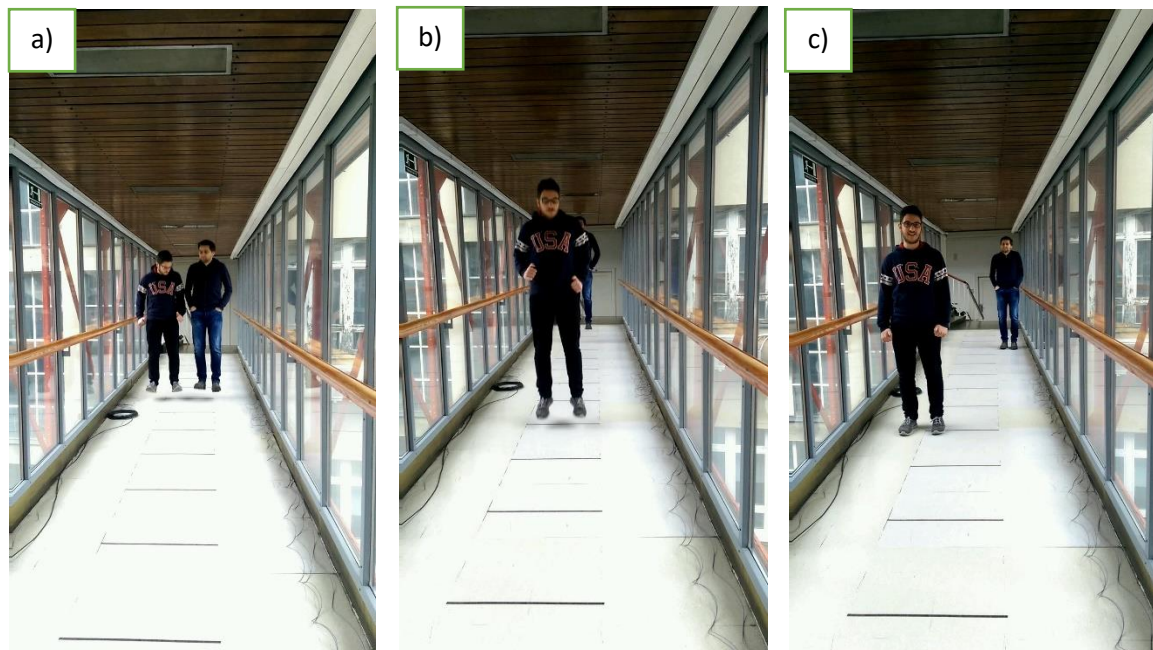
Slika 9.8. Impulsne pobude: a) skakanje u polovici raspona, b) skakanje u četvrtinama raspona i c) skakanje za dobivanje torzijskog oblika titranja
