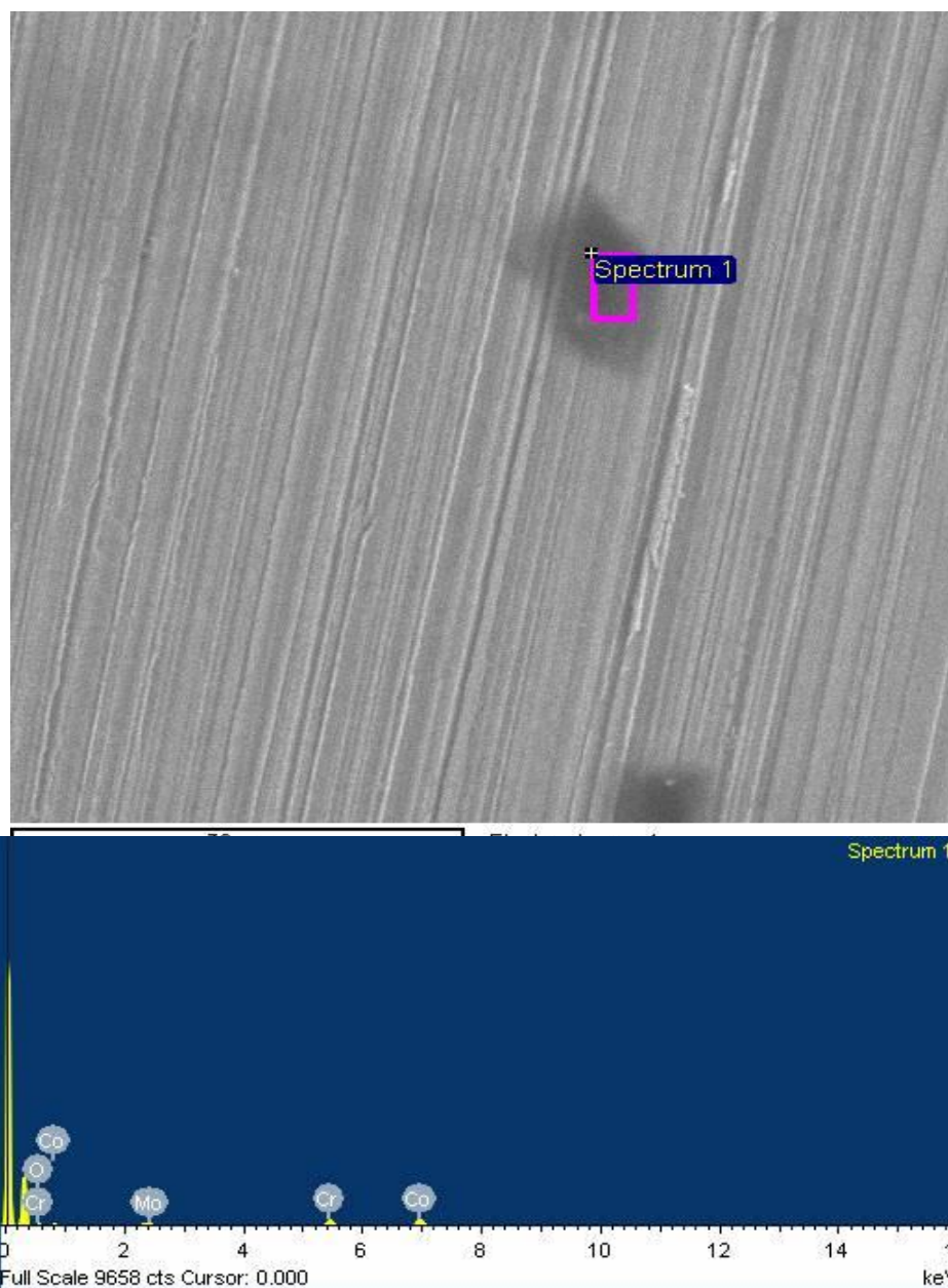
Slika 57. EDS spektar na mjestu pojave korozijskog produkta za neprevučeni uzorak CoCrMo legure
