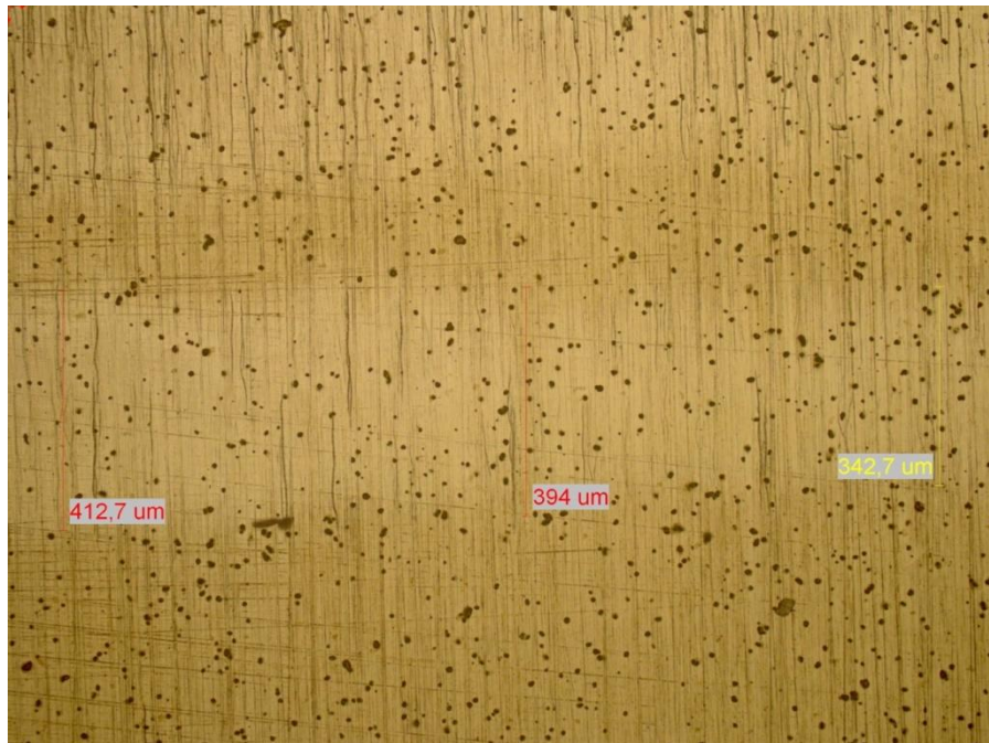
Slika 47. Trag trošenja snimljen na svjetlosnom mikroskopu sa povećanjem 100x a) Ne-prevučene legure CoCrMo Micro Melt b) CoCrMo Micro Melt prevučene prevlakom TiN
