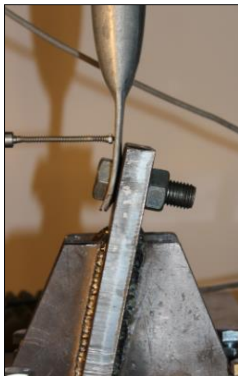
Slika 4.28 Početno stanje i početak deformiranja vlačno opterećenog uzorka T1
