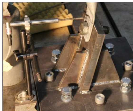
Slika 4.7 Razmještaj mjernih uređaja
