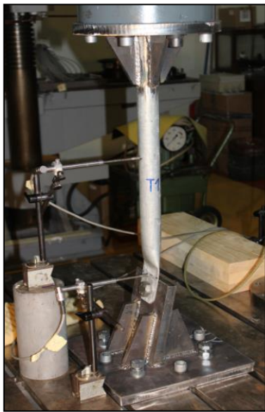
Slika 4.6 Razmještaj uzoraka i dodatne opreme za ispitivanje na vlak
