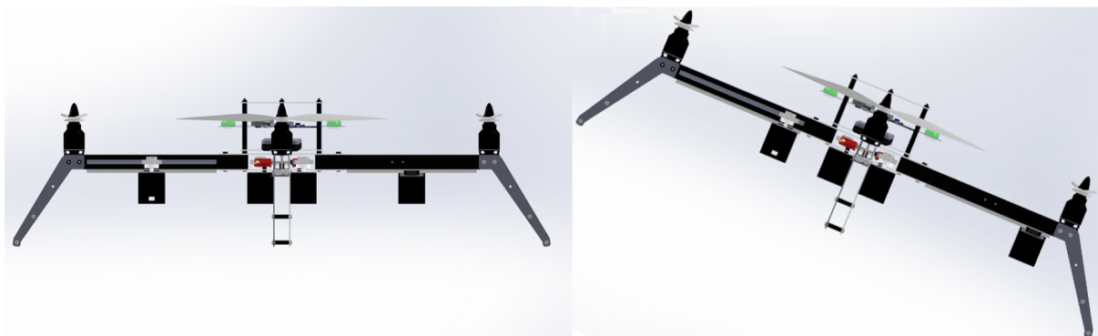
Slika 2: Utjecaj pomaka pokretne mase na položaj letjelice
