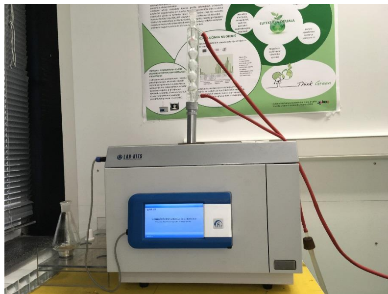
Slika 8. Ultrazvučno-mikrovalni reaktor (vlastita fotografija).
