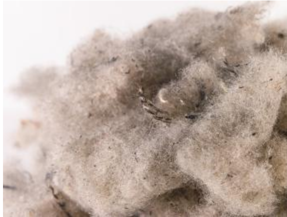
Slika 12 Pročišćena RTPF nakon drugog stadija mehaničkog pročišćavanja gume [49]
