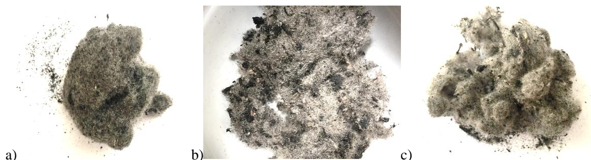
Slika 11 Polimerna vlakna nastala u procesu mehaničke reciklaže otpadnih guma: a) Vrsta 1 RTPF vlakana, b) Vrsta 2 RTPF vlakana c) Miješana RTPF (vrsta1 +vrsta2) [49]
