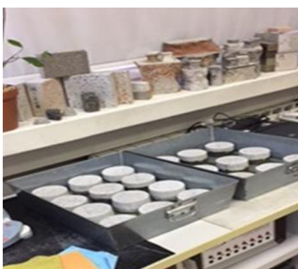
Slika 29 Ispitivanje kapilarnog upijanja tijekom 180 sati
