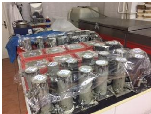
Slika 13 Način njegovanja uzoraka tijekom prva 24 sata
