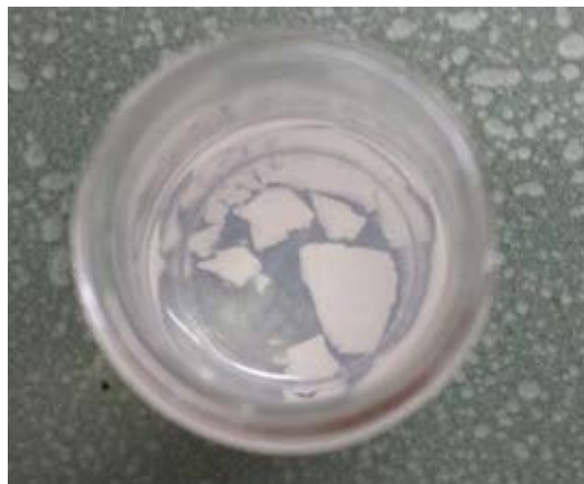
Slika 40. Ponašanje materijala Z-PCABS u acetone
