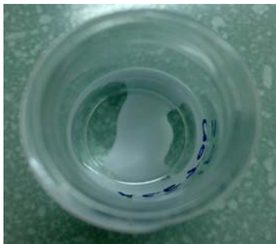
Slika 41. Ponašanje materijala Z-HIPS u acetonu
