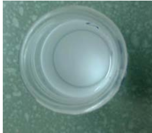
Slika 52. Ponašanje materijala ABS u acetone
