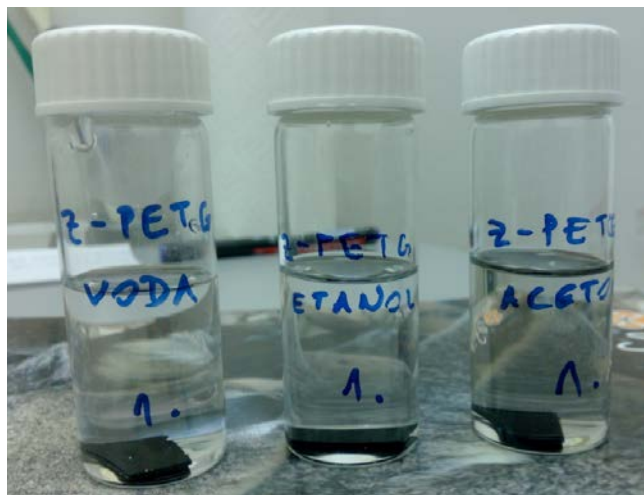
Slika 28. Pločice materijala (Z-PETG) uronjene u otapala
