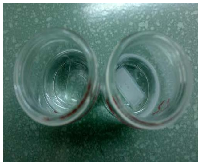
Slika 45. Ponašanje materijala Z-GLASS u vodi (lijevo) i acetonu (desno)
