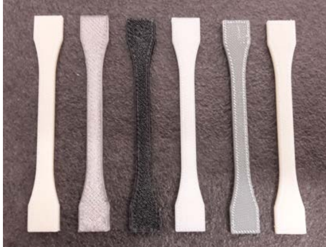
Slika 21. Ispitne epruvete tiskane na FDM pisaču
