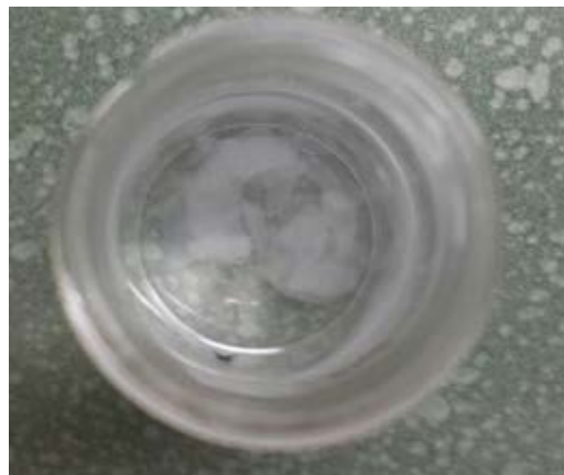
Slika 49. Ponašanje materijala PLA u acetone
