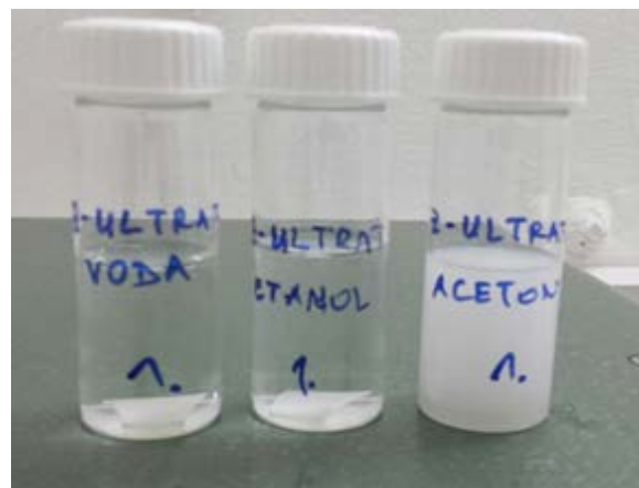
Slika 38. Ponašanje materijala Z-ULTRAT u sva tri otapala
