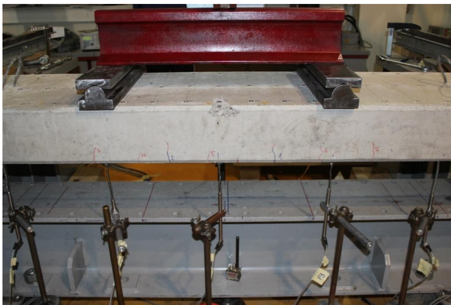
Slika 37. Pukotine nakon 1. FAZE opterećenja ( M = 15 \text{ kNm} )
