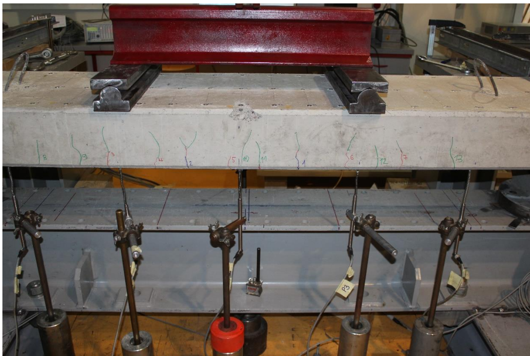
Slika 43. Pukotine nakon 2. FAZE opterećenja ( M = 30 \text{ kNm} )
