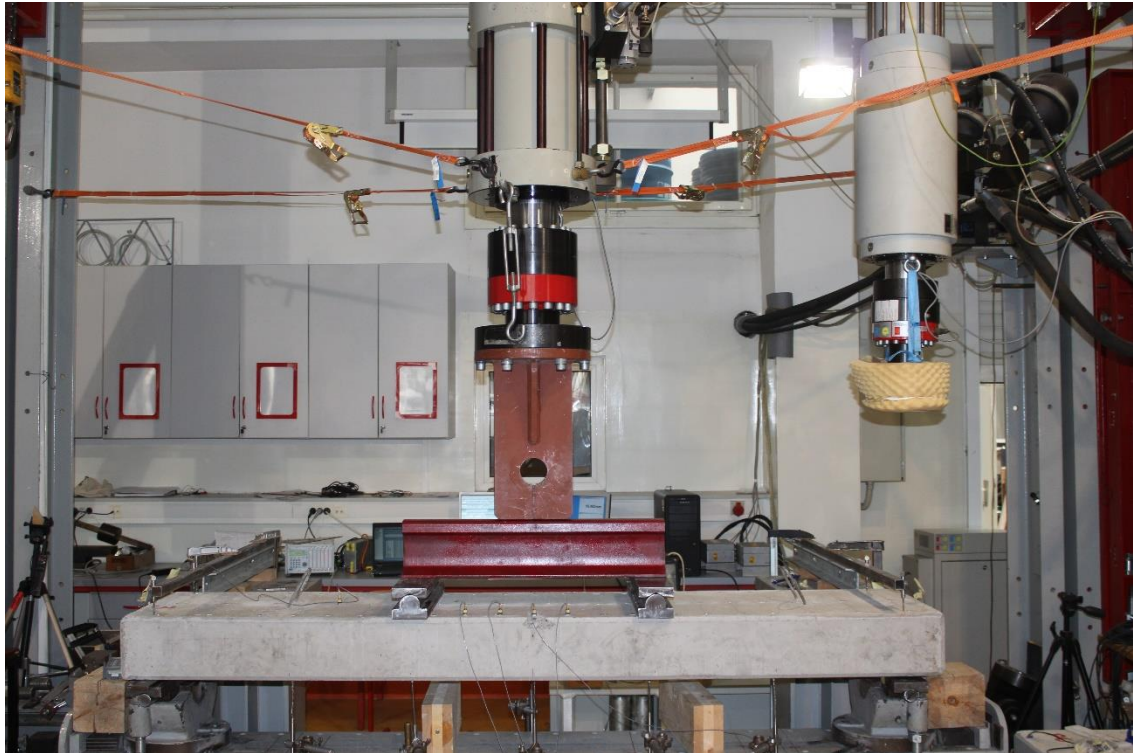
Slika 18. Nanošenje opterećenja ispitnim strojem
