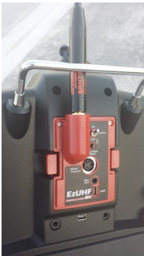
Slika 61. EzUHF modul u obliku JR, koji se spaja na stražnju stranu upravljačke stanice, [25]
