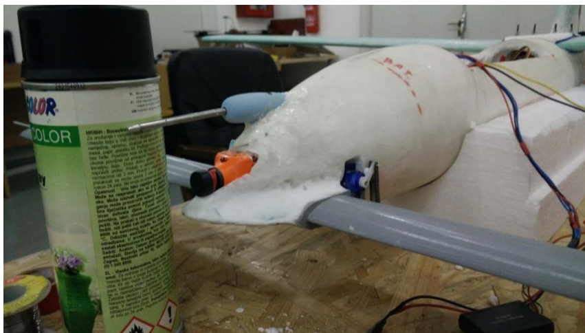
Slika 47. Postavljeni nosač Pitot cijevi na nos bespilotne letjelice
