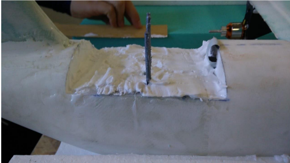
Slika 53. Epoksidna smola povećane gustoće za poboljšanje dosjeda krila
