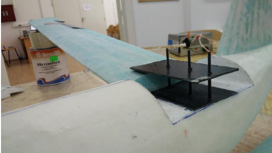
Slika 49. Priprema i lijepljenje komponenti spoja krilo-trup
