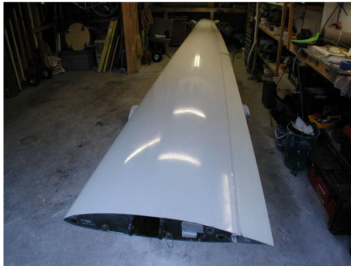
Slika 34. Izgled površine nakon završne obrade kompozitne komponente, [15]
