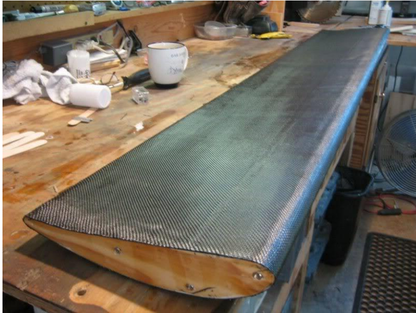
Slika 33. Izgled površine prije završne obrade kompozitne komponente, [14]
