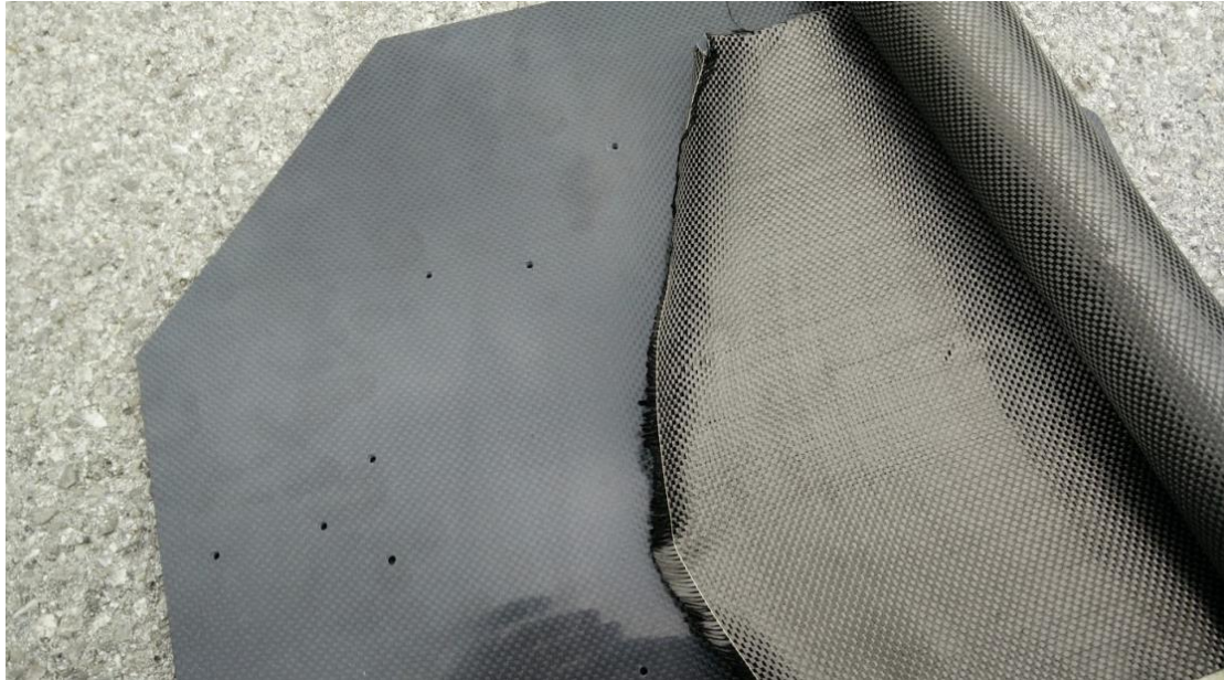
Slika 28. Ugljična ploča lijevo, ugljična vlakna desno
