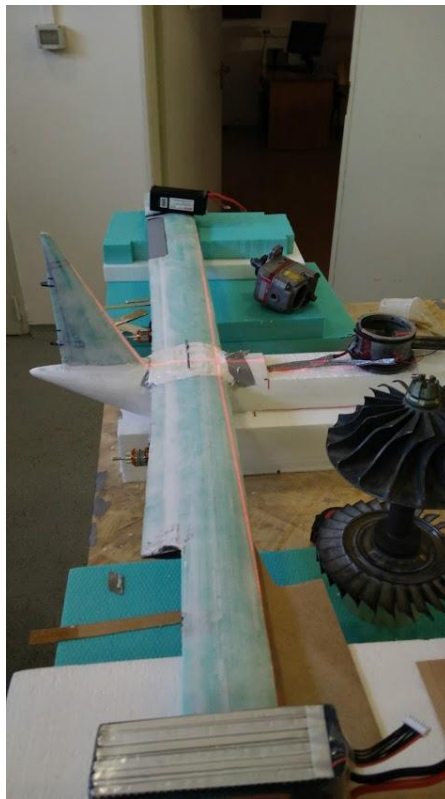
Slika 54. Centriranje komponenti i poboljšanje poklopca krila
