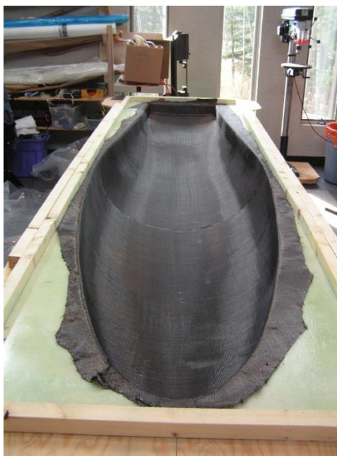
Slika 31. Ugljična vlakna postavljena u kalup, [13]
