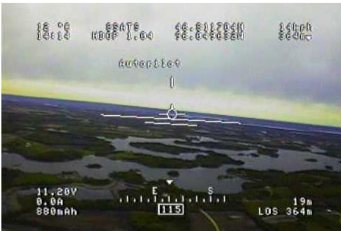
Slika 68. Specijalizirani sustav za bespilotne letjelice (eng. Range Video OSD, RVOSD ) koji osigurava u jednom uređaju autopilot, OSD, filtrirano napajanje, [32]
