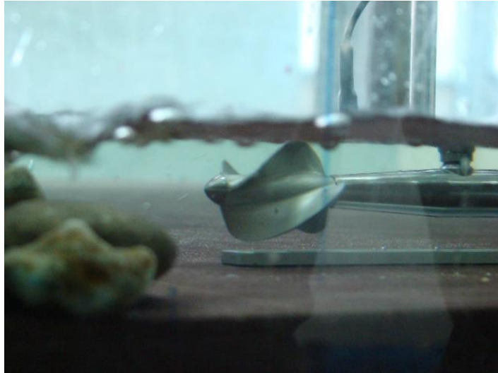
Slika 37. Podvodni prikaz propelera hidrometrijskog krila kojim mjerimo brzine
