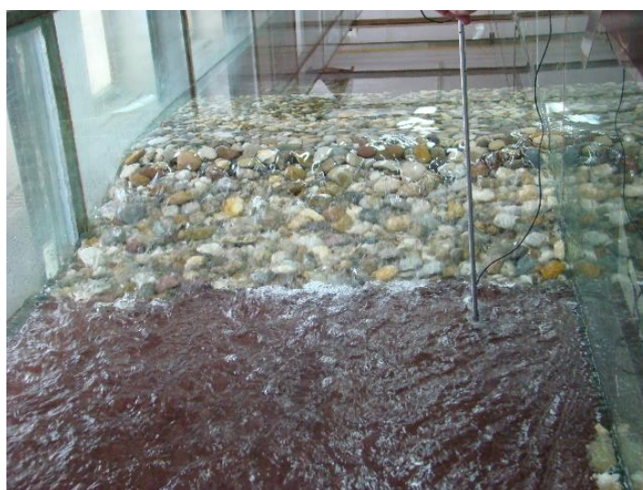
Slika 35. Mjerenje brzina pomoću hidrometrijskog krila
