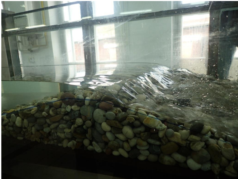
Slika 43. Poprečni prikaz sloma ravnog poprečnog praga i odnašanje krune
