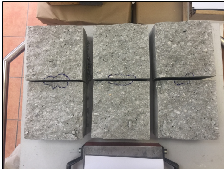
Slika 12. Rezultati ispitivanja vodopropunosti mješavine M3 nakon 28 dana
