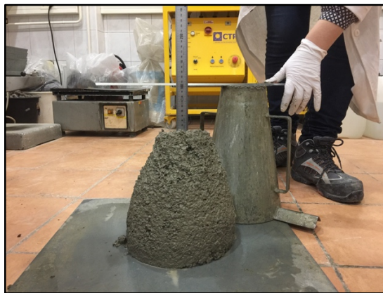
Slika 6. Ispitivanje konzistencije betona metodom slijeganja
