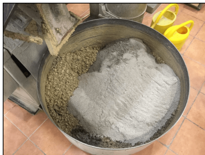
Slika 3. Komponente sastava betona prije početka miješanja
