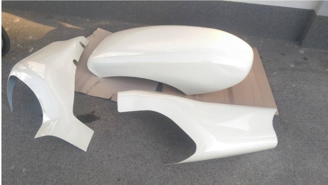
Slika 147. Oklop bolida nakon završne obrade i lakiranja.
