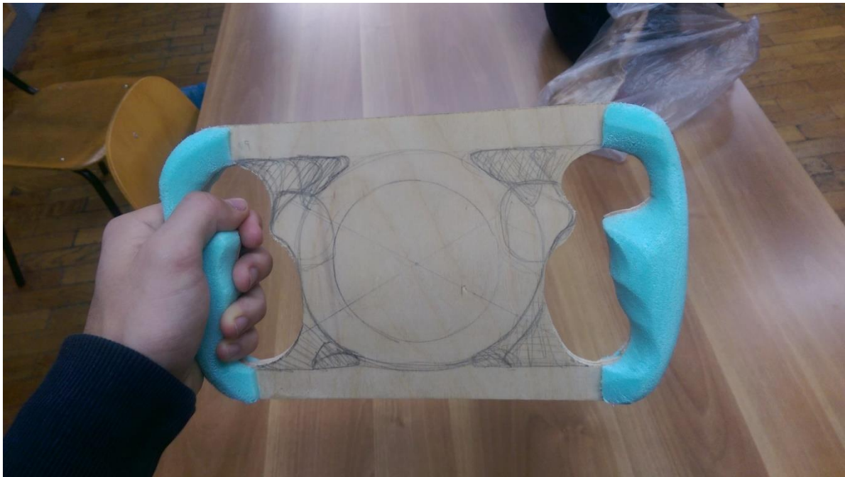
Slika 121. Ručno izrađen model ručkica iz stirodura.
