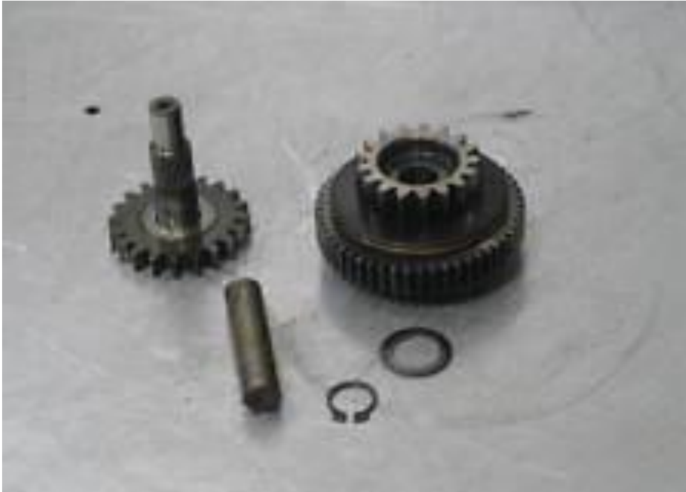
Slika 68. Tro stupanjska redukcija sustava za pokretanje motora.
