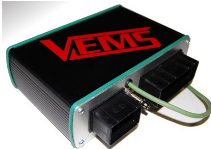
Slika 100. Centralna upravljačka jedinica – VEMS[15].
