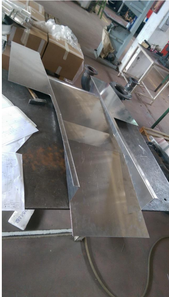
Slika 136. Negativ kalupa podnice nakon savijanja aluminijskog lima.
