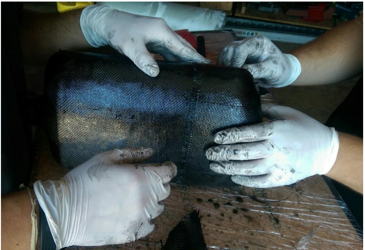
Slika 125. Proces ručne laminacije plenuma.
