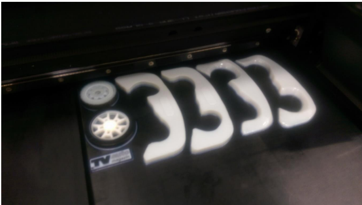
Slika 122. Proces 3D printanja ručkica volana.
