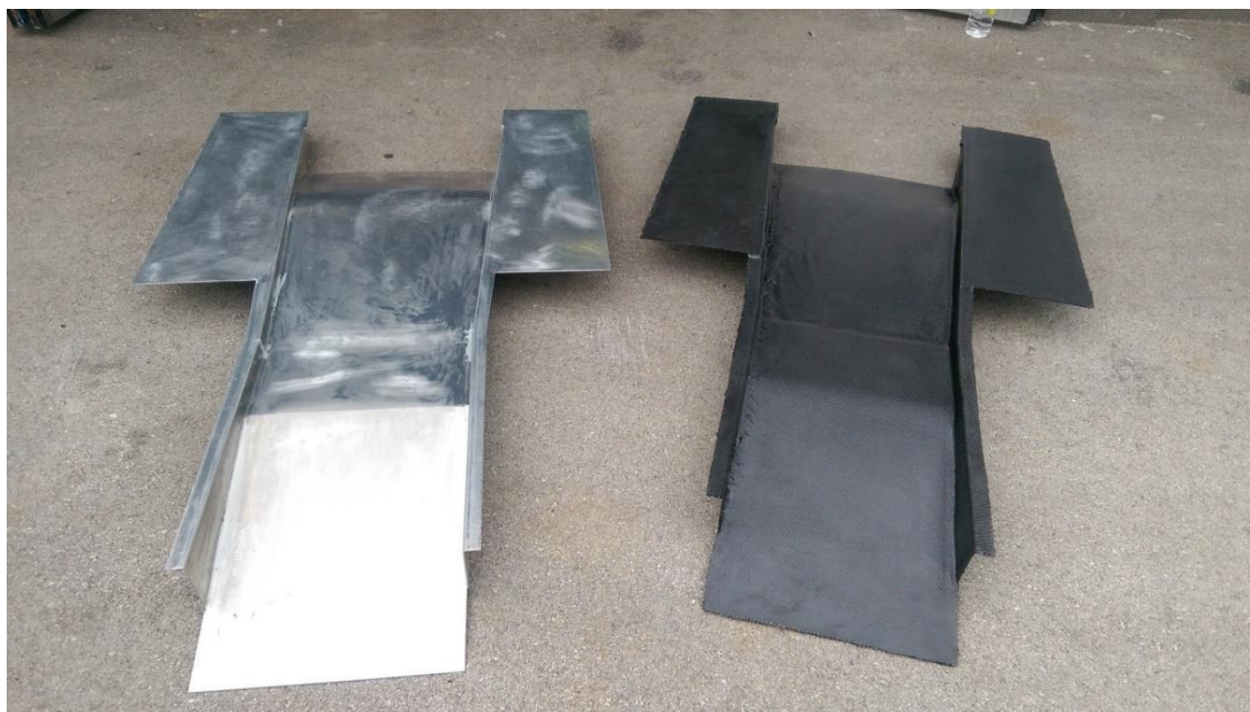
Slika 138. Usporedba kalupa podnice (lijevo) i gotove podnice od karbonskih vlakana (desno).
