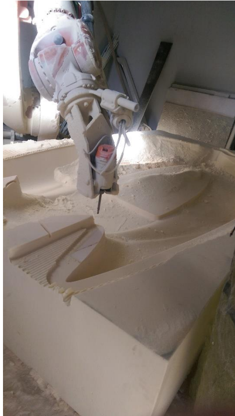
Slika 143. CNC glodanje kalupa za oklop bolida.
