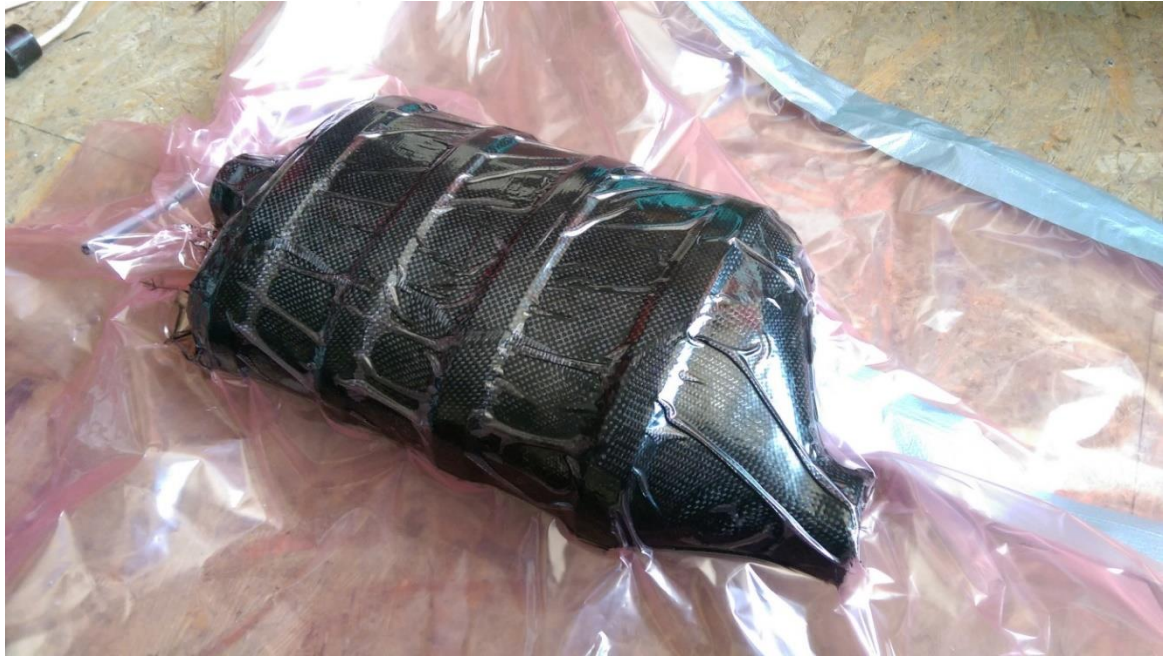
Slika 126. Vakuumsko istiskivanje viška smole nakon laminacije.
