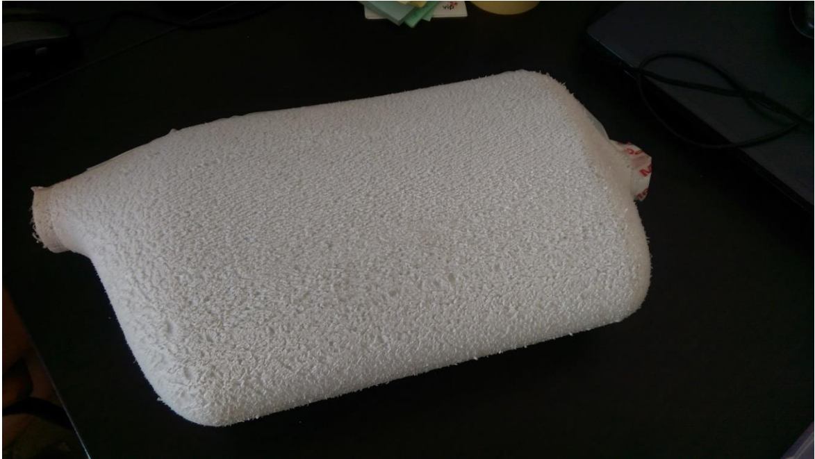
Slika 124. Kalup za laminiranje plenuma.
