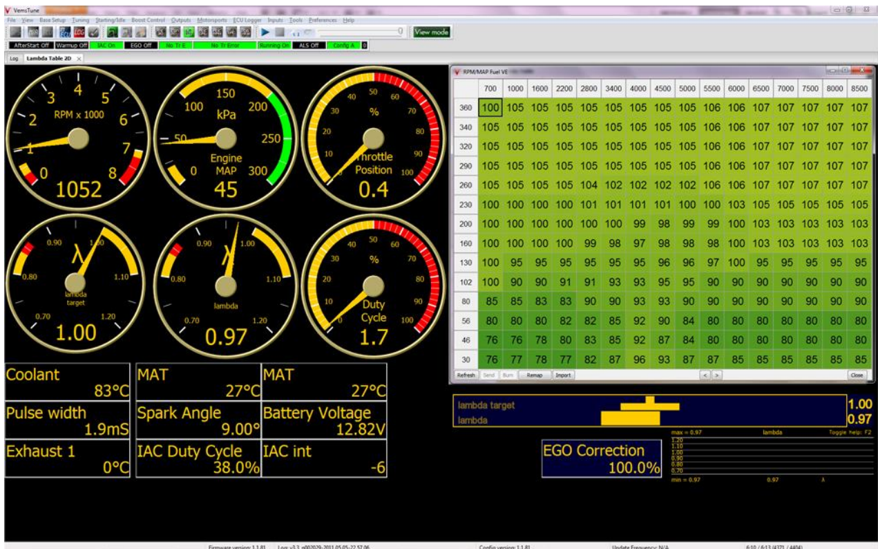
Slika 102. Prikaz sučelja aplikacije VEMS Tune unutar kojeg se mogu mijenjati parametri mape motora.
