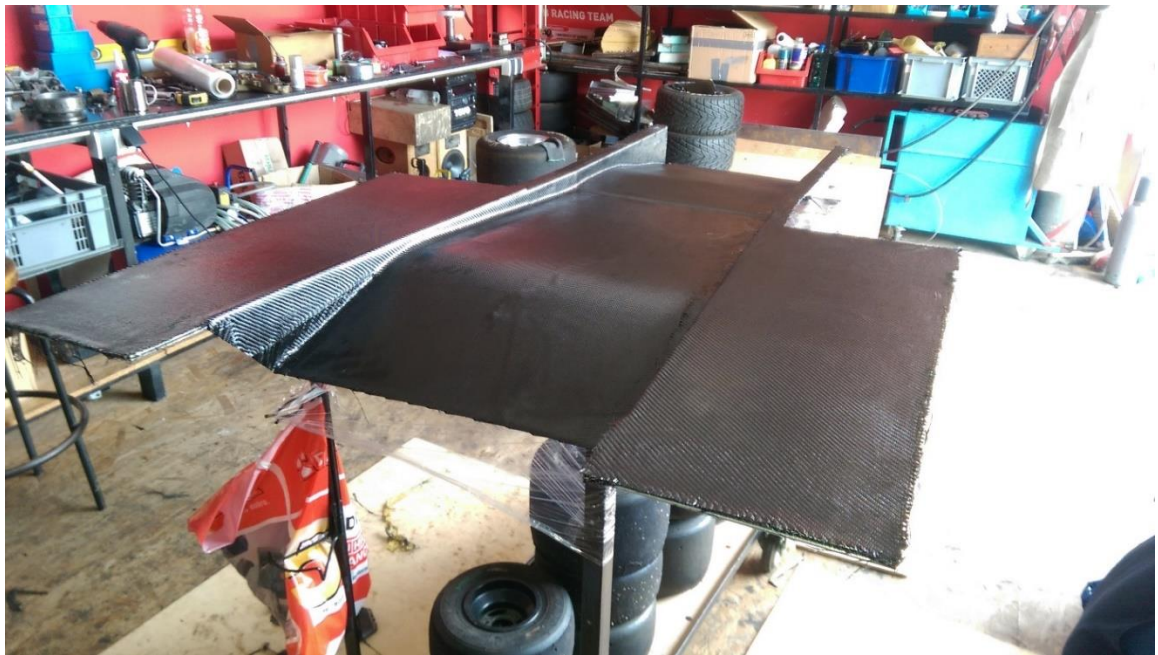
Slika 137. Proces ručne laminacije karbonskih vlakana u kalup podnice.
