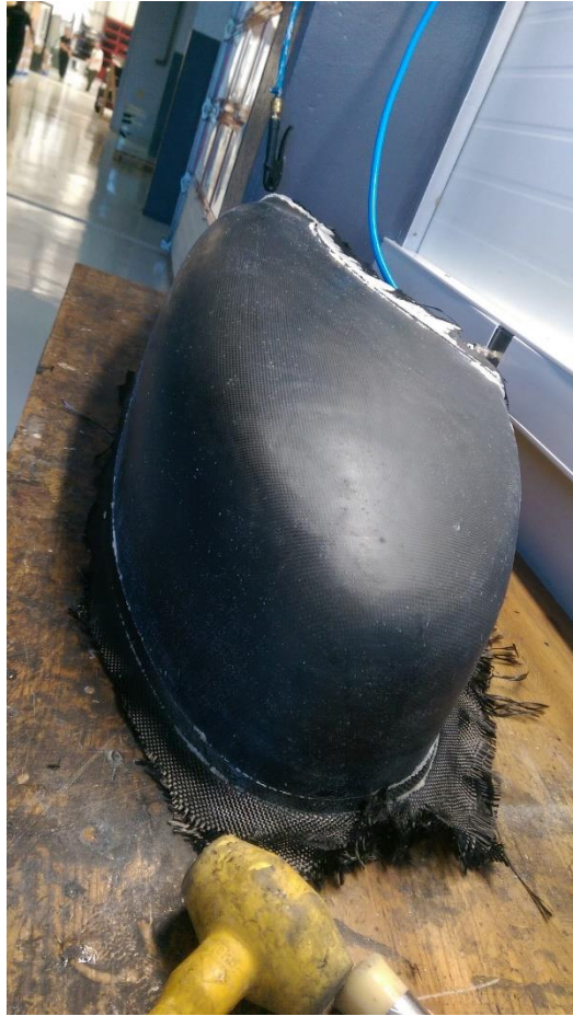
Slika 145. Dio karbonskog oklopa nakon vađenja iz kalupa.
