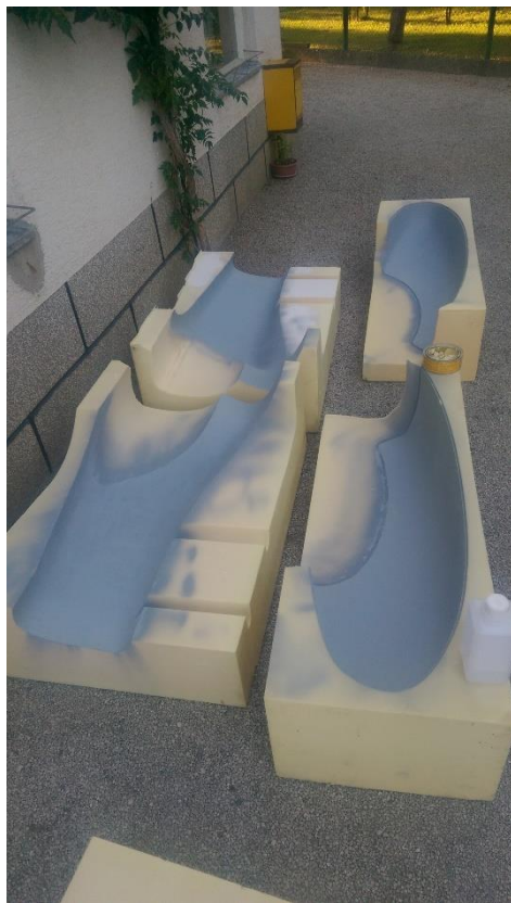
Slika 144. Obradeni kalupi spremni za laminiranje karbonskih vlakana.
