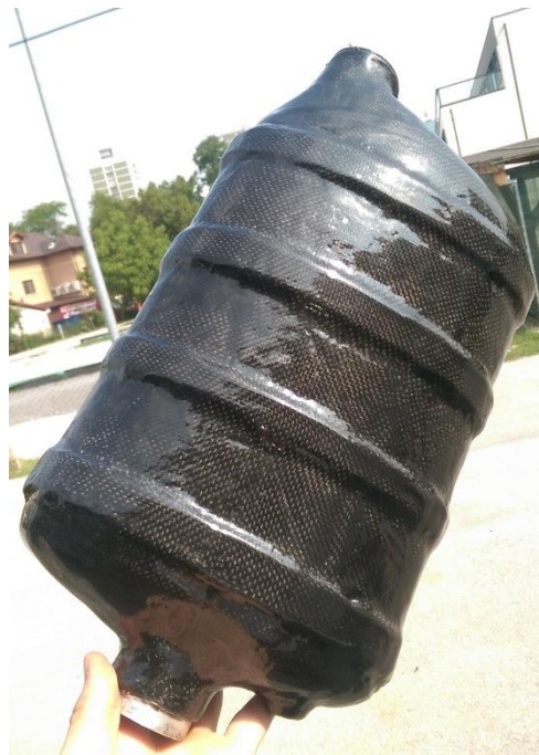
Slika 127. Konačan izgled plenuma nakon poliranja i završne obrade.
