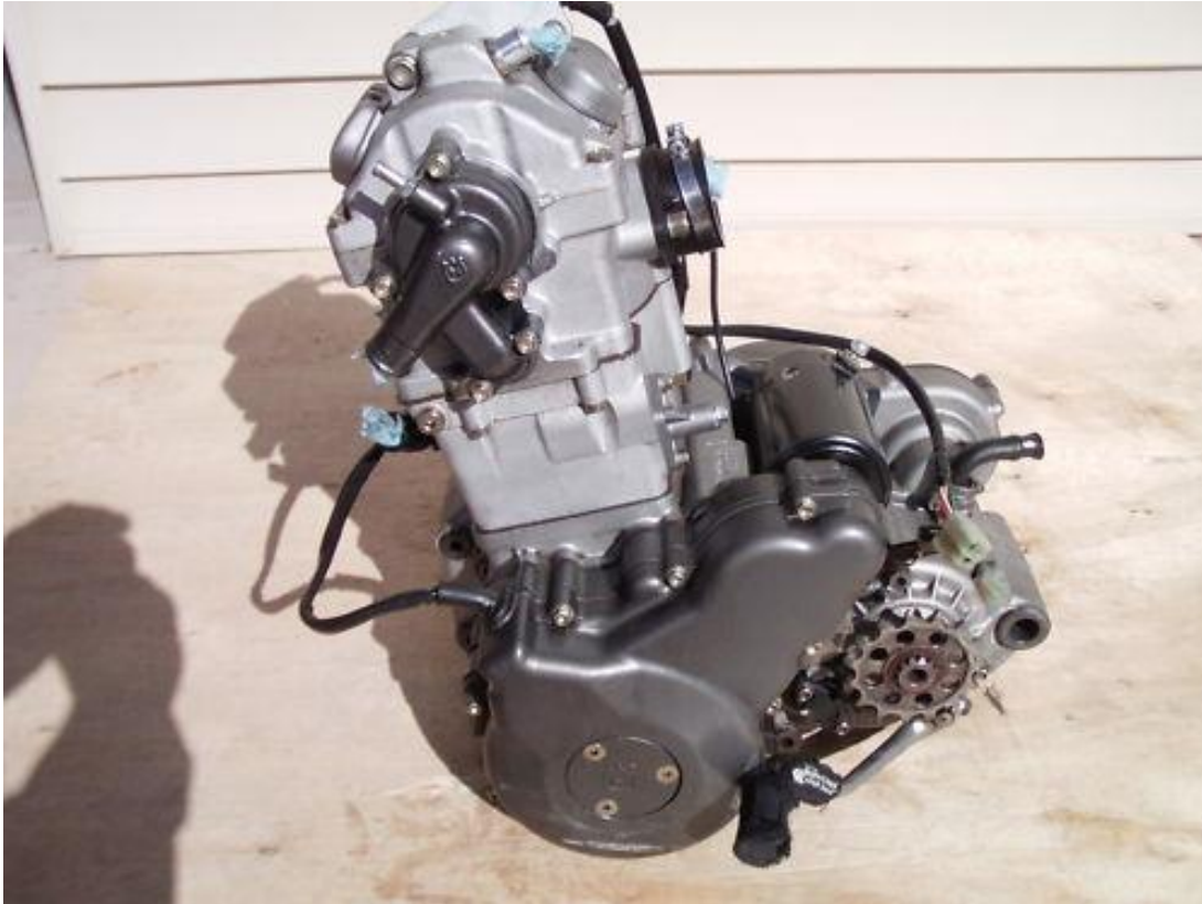
Slika 53. Jednocilindrični motor proizvođača Husqvarna, mase 42 kg.
