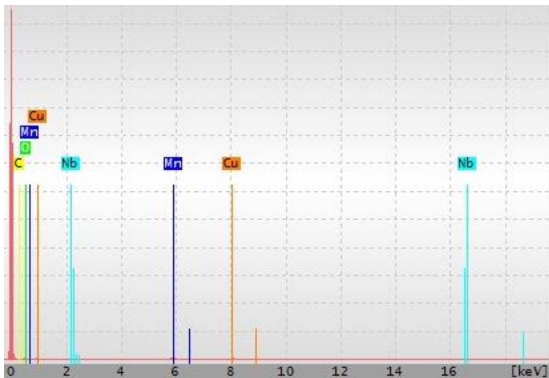
Slika 4.2. Rezultati EDX analize Mn-Cu katalizatora
