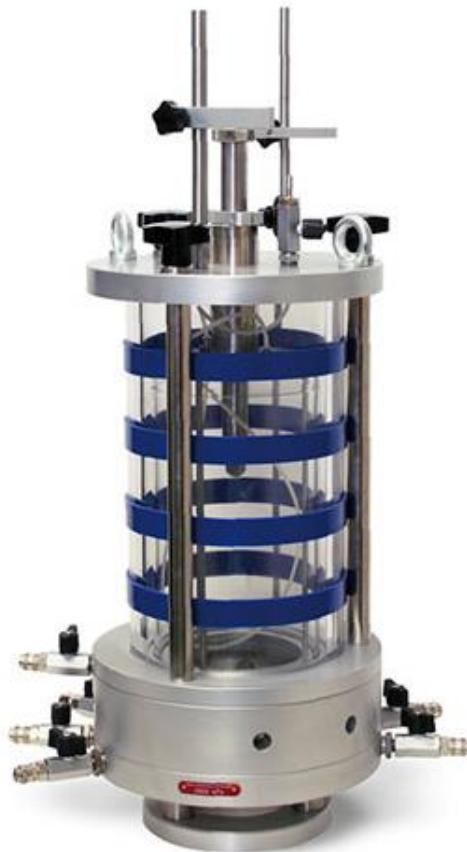
Slika 4.9. Modificirana troosna ćelija [25]
