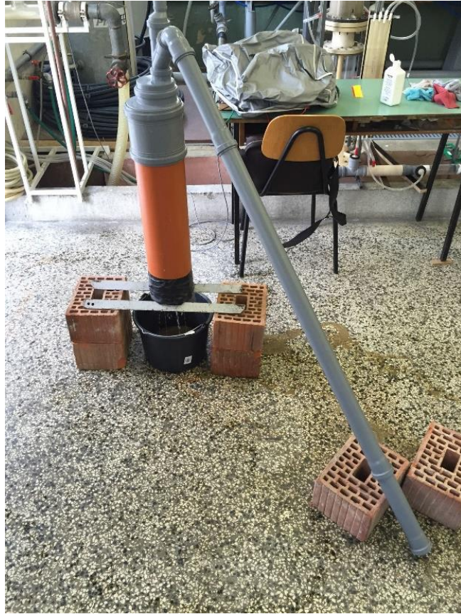
Slika 3.18. Ispitivanje propusnosti uzorka bez ekspandirajuće smole
