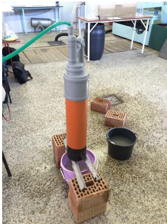
Slika 3.17. Postupak ispitivanja uzorka u prirodnom stanju (bez ekspanzirajuće smole)
