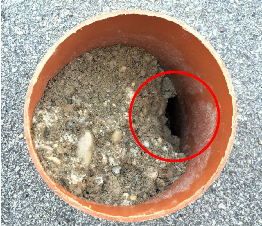
Slika 4.5. Dio poprečnog presjeka uzorka šljunka nezahvaćen ekspanzirajućom poliuretanskom smolom
