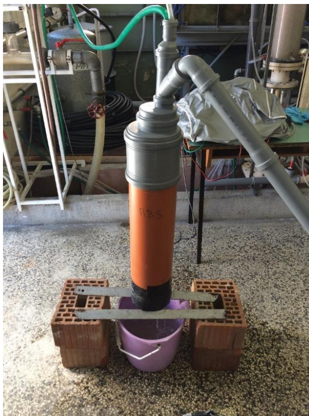
Slika 4.3. Mjerenje volumena za uzorak s mješavinom pijeska i šljunka
