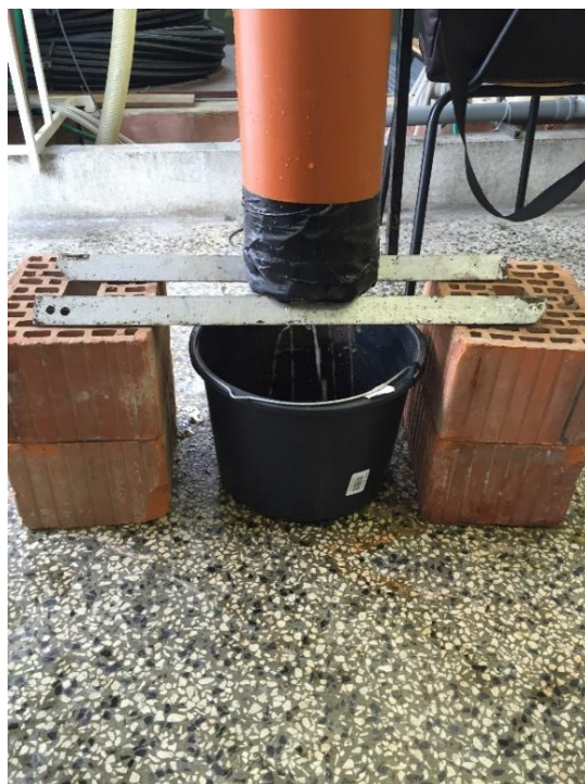
Slika 4.2. Mjerenje volumena za uzorak sa šljunkom
