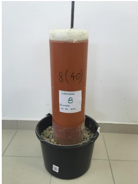
Slika 3.12. Primjer pripremljenog uzorka šljunka za injektiranje
