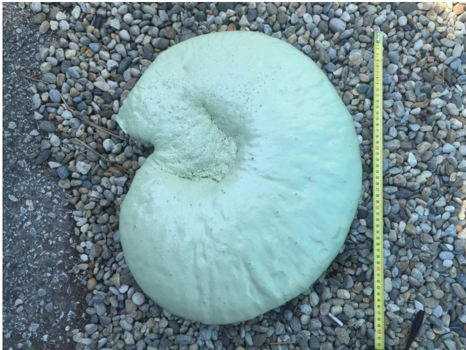
Slika 1.12. Prikaz uzorka 250 [ml] ekspandirajuće smole pri slobodnom širenju
