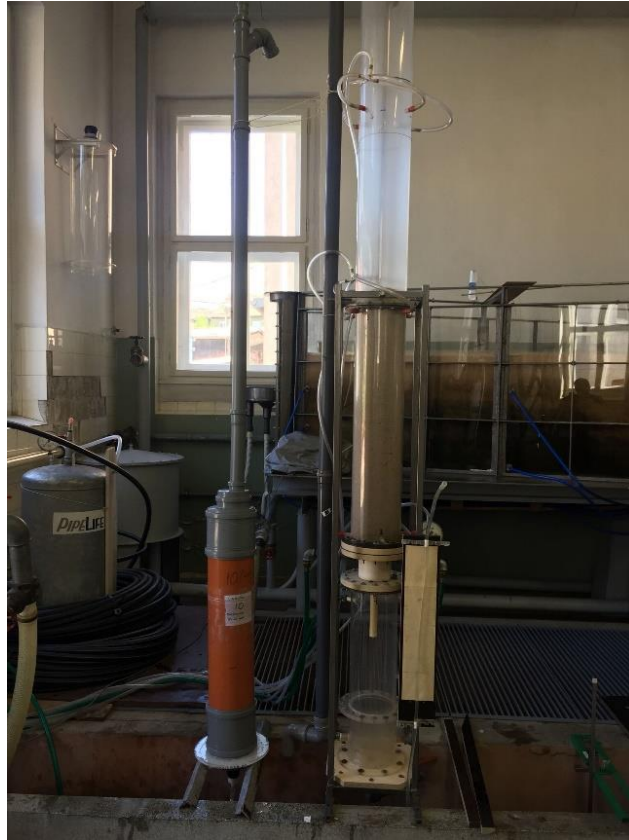
Slika 3.19. Ispitivanje uzorka s ekspandirajućom smolom
