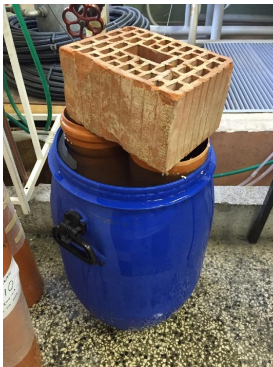
Slika 4.5. Saturacija uzorka s mješavinom pijeska i šljunka
