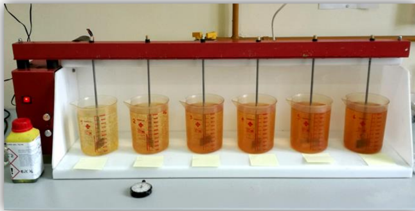
Slika 5. Jar test s rastućim koncentracijama FeCl 3 s lijeva na desno.
