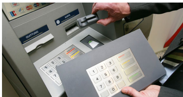
Slika 3.5: Skimmer - lažni čitač kartica i tipkovnica za unos PIN-a
