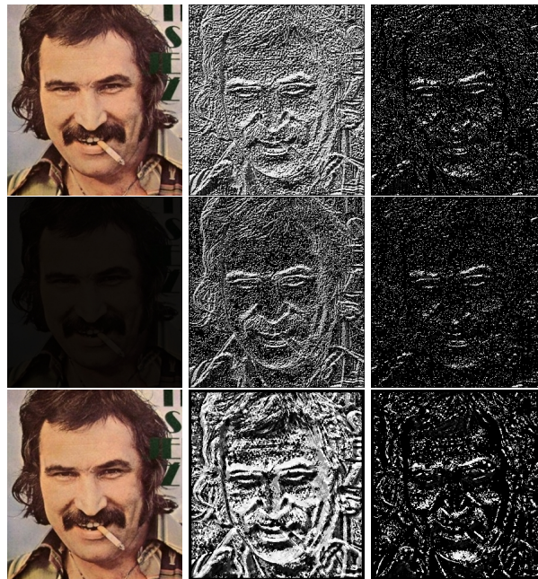
Slika 4.13: LBP slike dobivene ekstrakcijom LBP uzoraka. Originalna slika (lijevo), LBP deskriptor (sredina), LBP deskriptor ujednačenih uzoraka(desno). Prvi red - normalni LBP deskriptor, drugi red - smanjena iluminacija, treći red - LBP deskriptor s povećanim radijusom.
