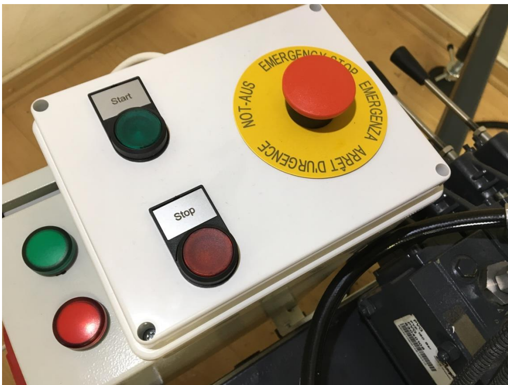
Slika 2.12. Upravljačka kutija za sigurno uključivanje i isključivanje napajanja proporcionalnog ventilskog bloka manipulatora
