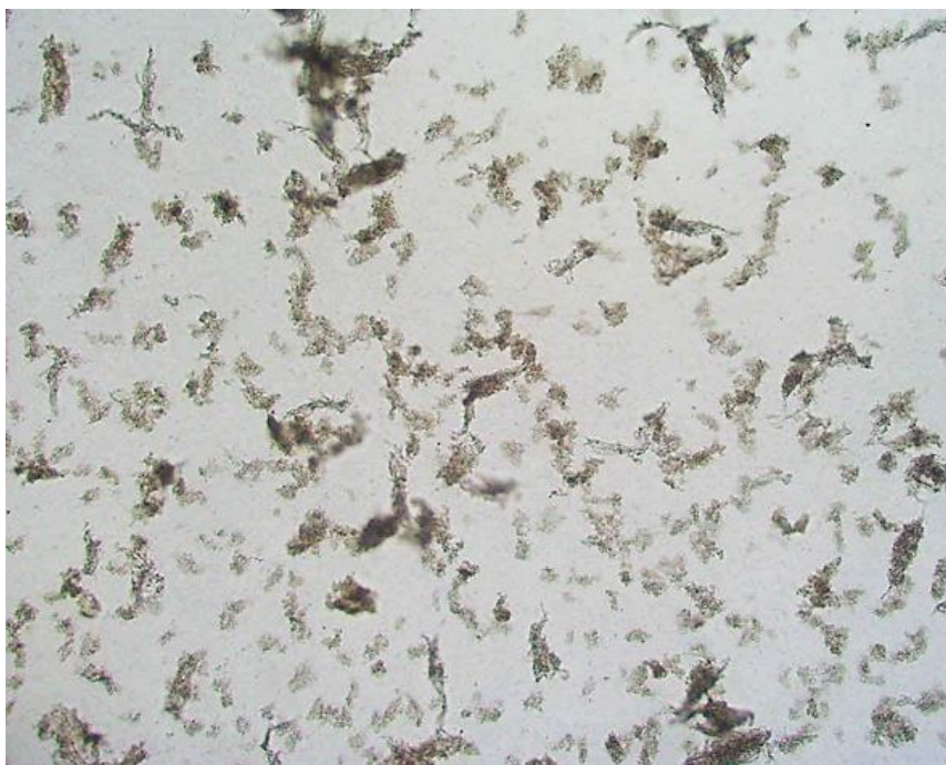
Slika 4.16. Mikrofotografija pahuljica aktivnog mulja u 24. satu provedbe procesa stvaranja pahuljica aktivnoga mulja u P1 snimljene u prolaznoj svjetlosti, P = 100×.
