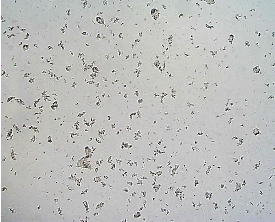
Slika 4.17. Mikrofotografija pahuljica aktivnog mulja u 24. satu provedbe procesa stvaranja pahuljica aktivnoga mulja u P2 snimljene u prolaznoj svjetlosti, P = 100×.
