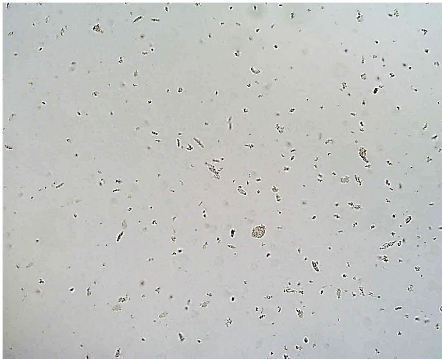
Slika 4.17. Mikrofotografija pahuljica aktivnog mulja u 24. satu provedbe procesa stvaranja pahuljica aktivnoga mulja u P2 snimljene u prolaznoj svjetlosti, P = 100×.
