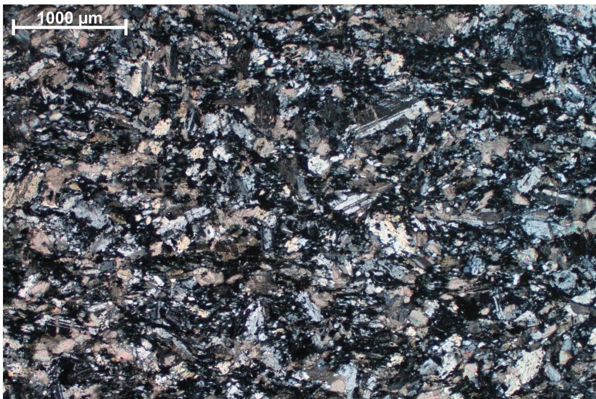
Slika 4.14: (A) Mikrofotografija uzorka ADO1. Granolepidoblastična struktura, folijacija definirana agregatima klorita. Krupnija bezbojna zrna su plagioklasi i kalcit. Plagioklasi mjestimično kaolinitizirani, kalcit s razvijenim deformacijskim sraslacima. N- (B) N+.
