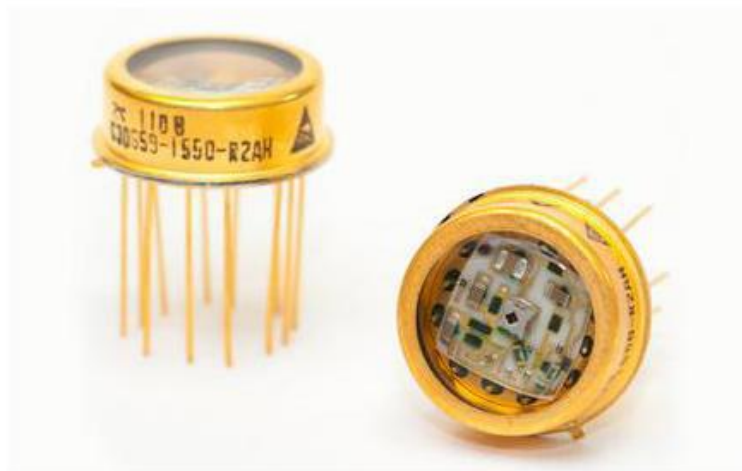
Slika 4. Fotodioda s lavinskom multiplikacijom s ugrađenim pojačalom
