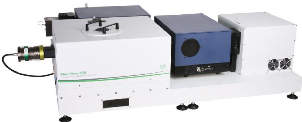
Slika 5. Spektrometar koji u svom radu koristi SPAD
