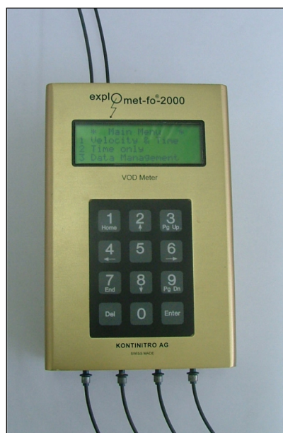
Slika 4-4. Elektronički sat Explomet – Fo 2000.
