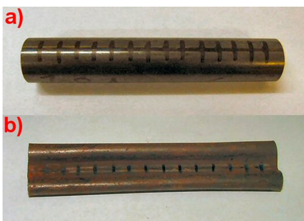
Slika 4-12. Određivanje deformacije ispitne cijevi.
