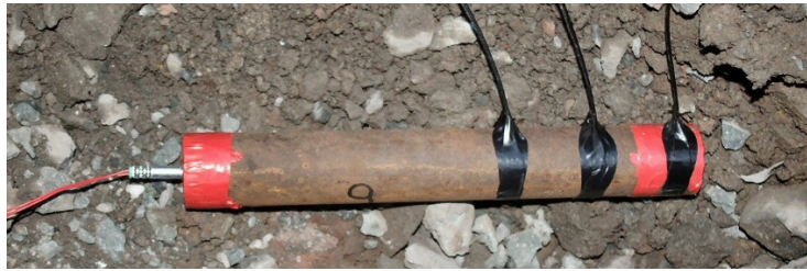
Slika 4-8. Fotografija mjerenja – iniciranje detonatorom.
