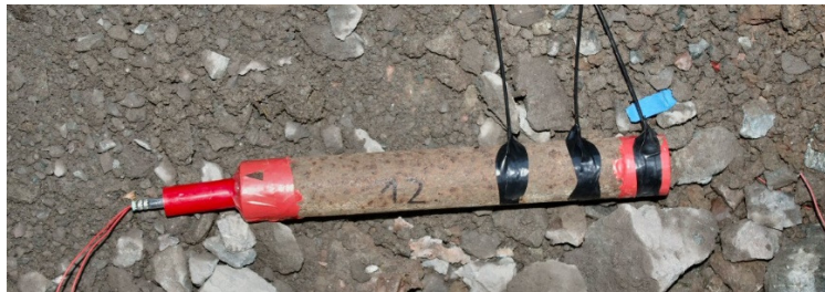
Slika 4-9. Fotografija mjerenja – iniciranje pojačnikom.
