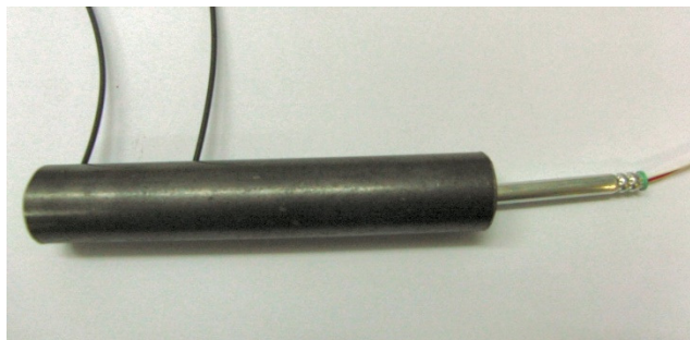
Slika 4-6. Fotografija mjernog postava u čeličnoj cijevi unutarnjeg promjera \varnothing 20 mm.
