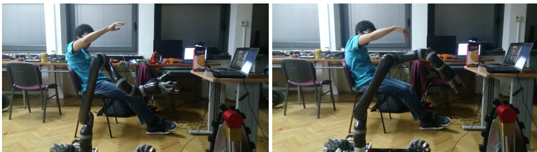
Slika 8.6: Prikaz upravljanja orijentacijom izvršnog člana.
