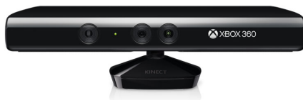
Slika 3.1: RGB-Dubinska kamera Kinect for Xbox 360
