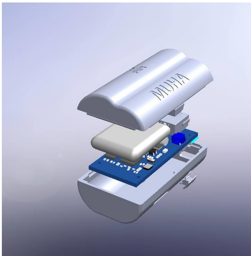
Slika 8. Sastavni dijelovi uređaja: kućište, baterija i tiskana pločica
