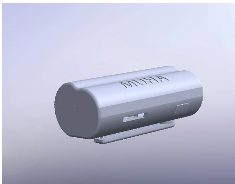
Slika 9. Sklopljeni uređaj. Može se vidjeti utor za SD karticu, tipka za uključenje/isključenje te kvačica za jednostavnije pričvršćivanje uređaja za odjeću korisnika
