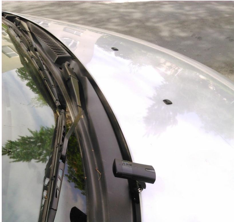
Slika 9. Prikaz postavljanja GNSS uređaja na automobil
