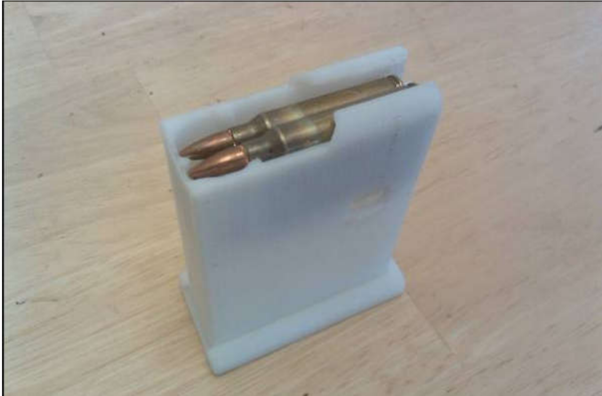
Slika 16. Okvir za metke izrađen 3D printanjem [70].
