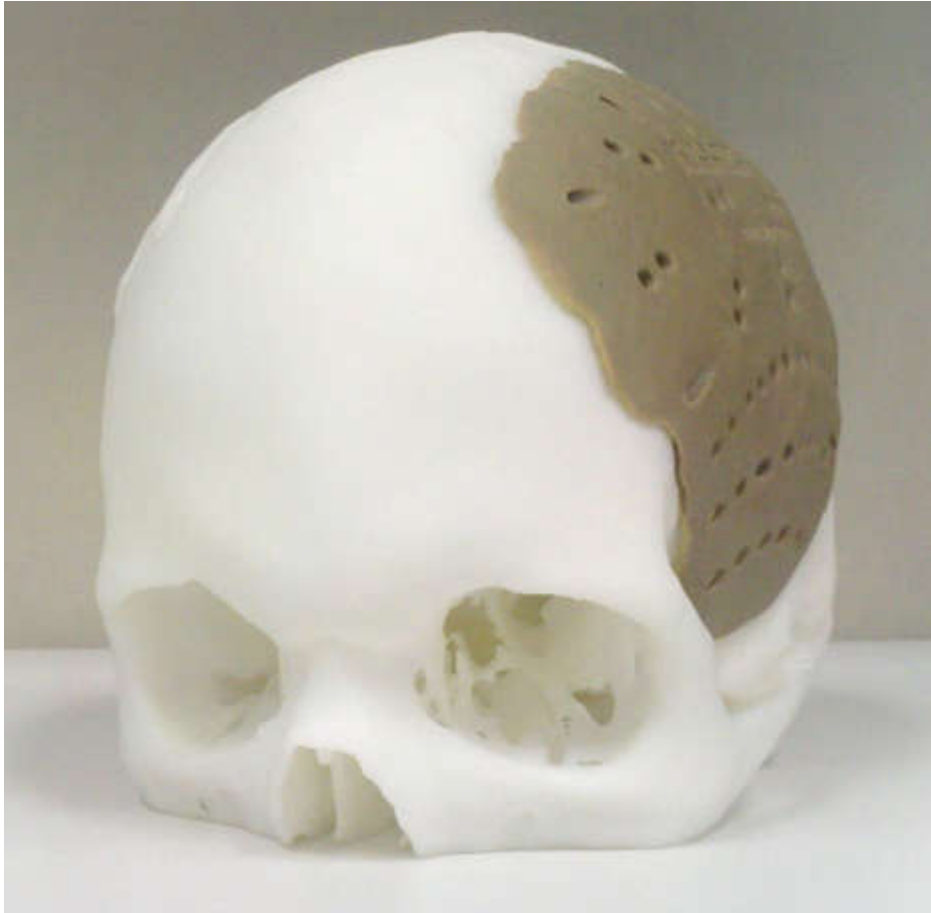
Slika 18. Primjer 3D isprintanoga dijela lubanje [72].
