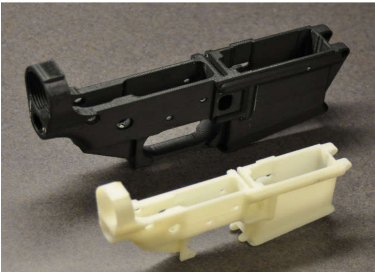
Slika 17. Konstrukcijski dijelovi oružja izrađeni 3D printanjem [71].
