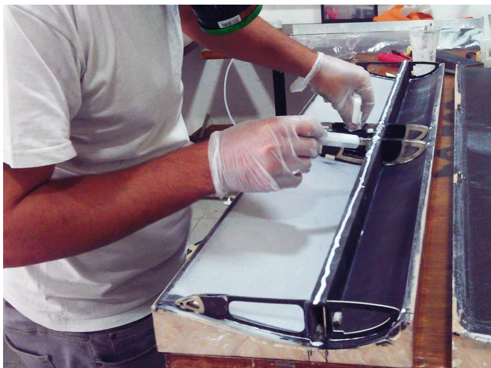
Slika 5.29 Nanošenje ljepila na ramenjaču
