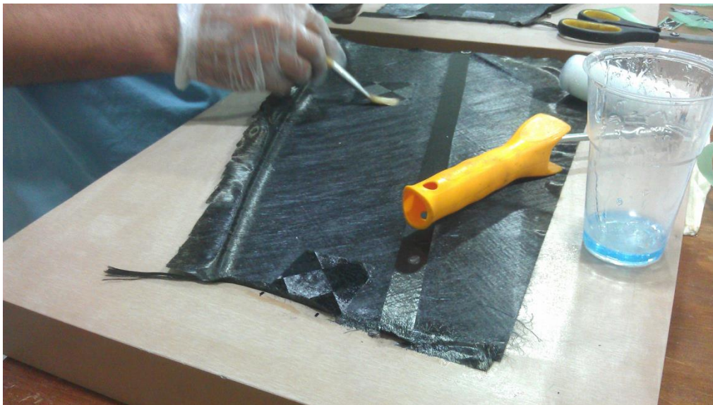
Slika 5.40 Dodatno ojačani dijelovi repa
