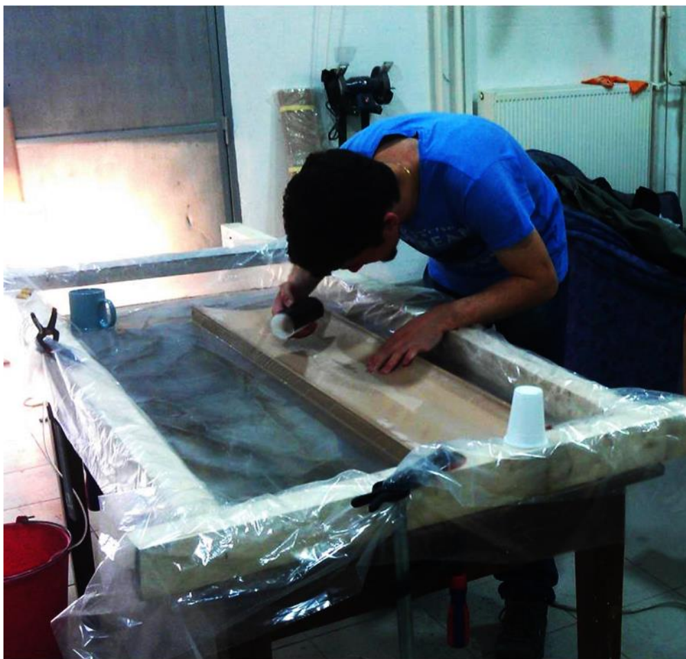
Slika 5.25 Brušenje kalupa krila
