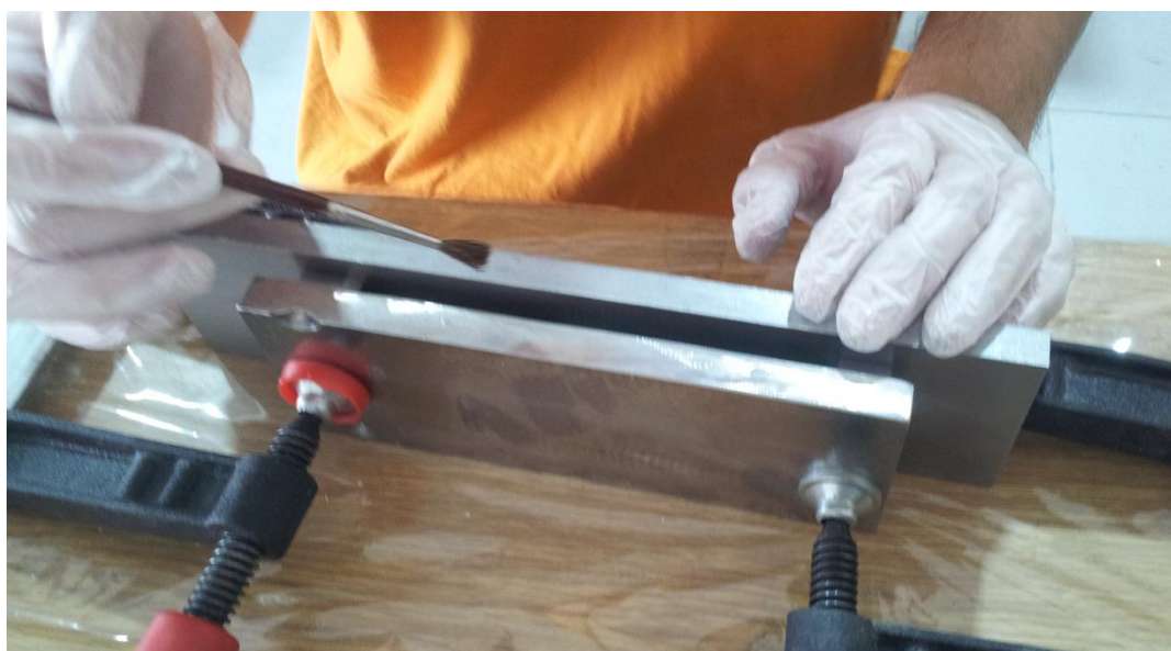
Slika 5.23 Izrada spojnice krila
