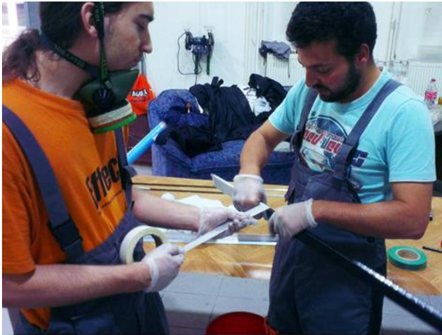
Slika 5.17 Omotavanje ramenjače najlonskim platnom
