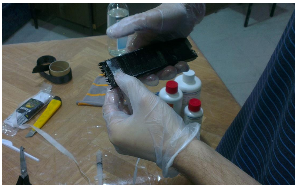
Slika 5.24 Izrada dosjeda za spojnicu krila
