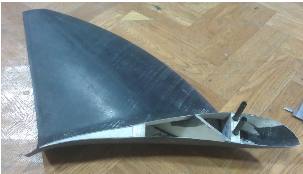
Slika 5.37 Izrađen završetak krila
