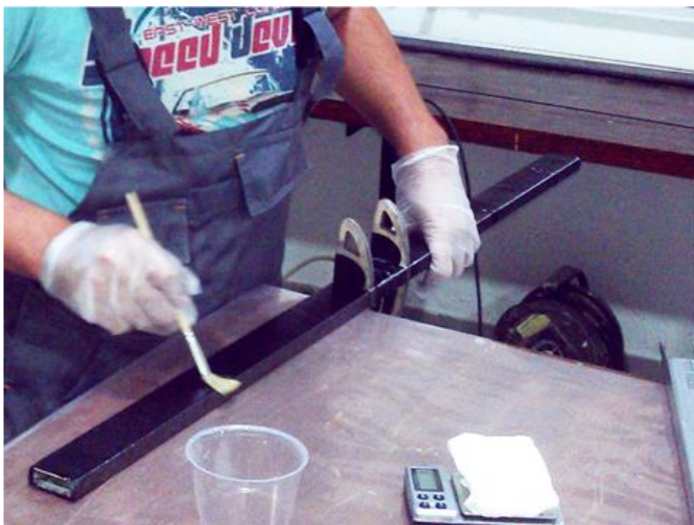
Slika 5.16 Nanošenje epoksidne smole
