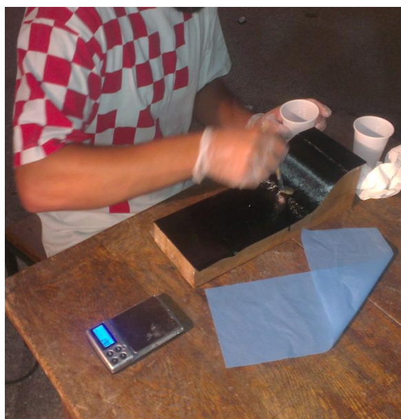
Slika 5.3 Izrada nosive ploče
