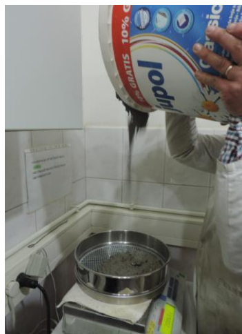
Slika 32 Ispitivanje segregacije sijanjem
