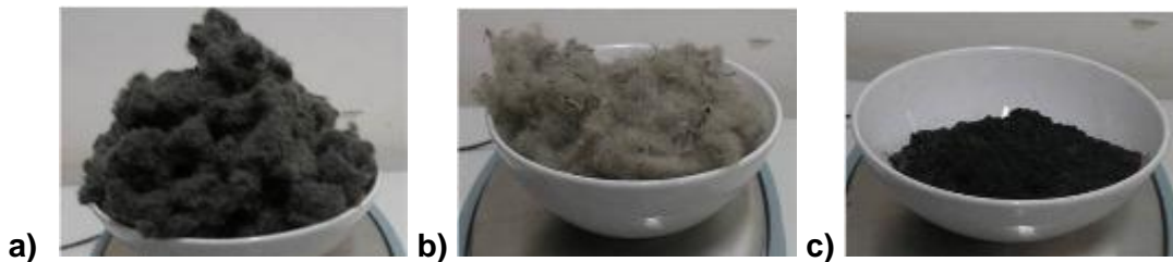
Slika 12 Prva faza čišćenja: a) onečišćena vlakna b) čista vlakna c) granule gume
