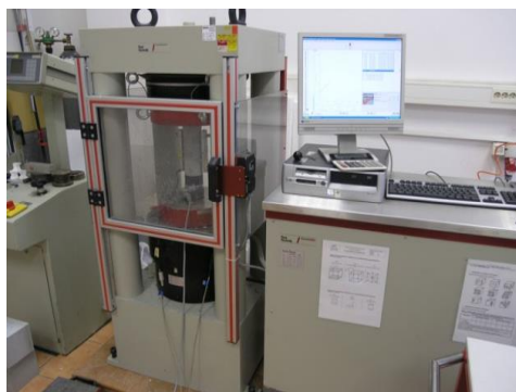
Slika 22 Preša za ispitivanje tlačne čvrstoće
