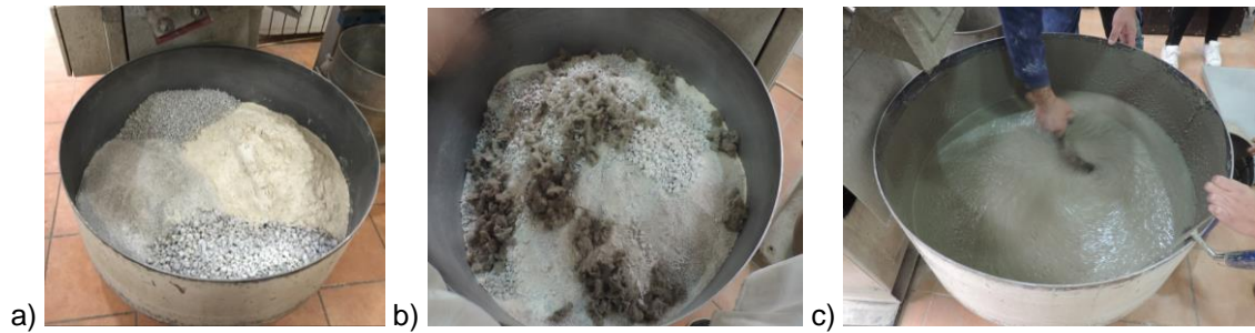
Slika 23 Postupak miješanja; a) suha komponenta b) dodatak vlakana c) vizualni pregled mješavine tijekom miješanja
