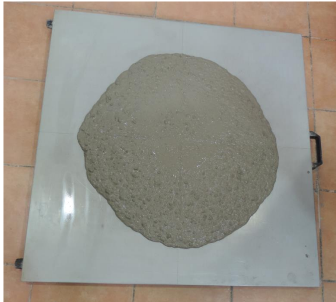
Slika 17 Ispitivanje rasprostiranja slijeganjem
