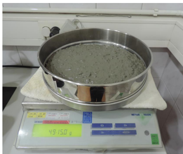
Slika 19 Ispitivanje segregacije sijanjem
