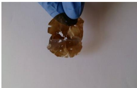
Slika 3.2.1. Uzorak GO dobiven sušenjem otopine
