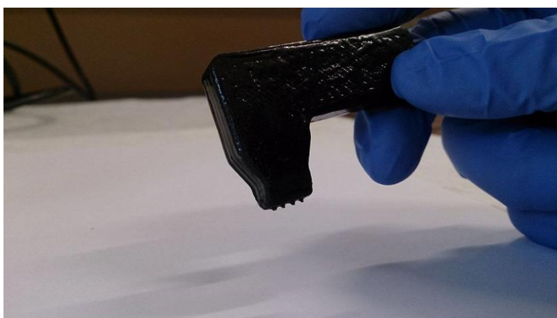
Slika 3.5.2. Sonda s četiri vrha za mjerenje električne provodnosti
