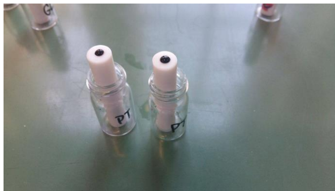
Slika 3.4.1. Disk elektrode na koje je nanesen uzorak rGO
