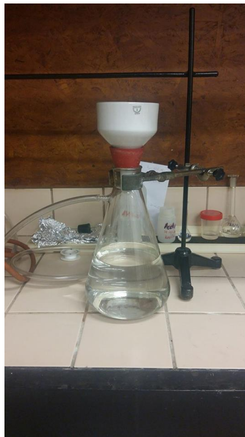
Slika 3.2.4. Filtriranje rGO kroz Buchnerov lijevak
