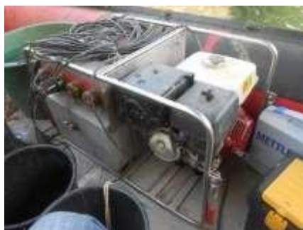
Slika 9 Elektro-agregat za omamljivanje riba EL63II-GI (Hans Grassl GmbH, Njemačka) snage 5,0 kW (snimila Vlatka Filipović Marijić)
