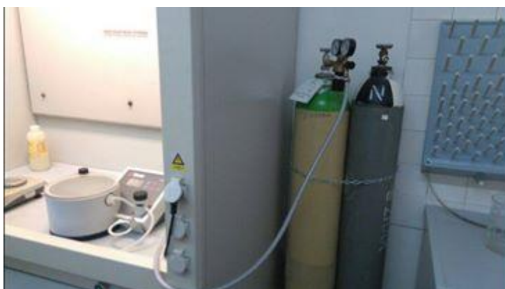
Slika 9. Uređaj za vakuusku impregnaciju (CitovacStruers)
