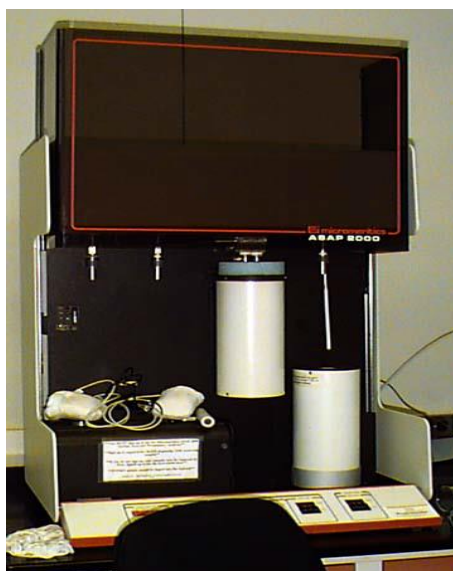
Slika 7. Uređaj za određivanje veličina pora, ASAP 2000 (Micromeritics, SAD)
