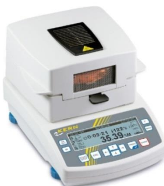
Slika 8. Uređaj za mjerenje vlage MLS 50-3C ( http://www.kern-sohn.com )
