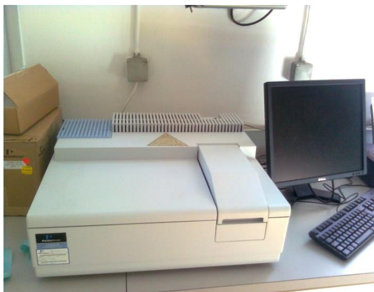
Slika 10. UV/VIS spektrofotometar Lambda 35 (PerkinElmer, Waltham, SAD)
