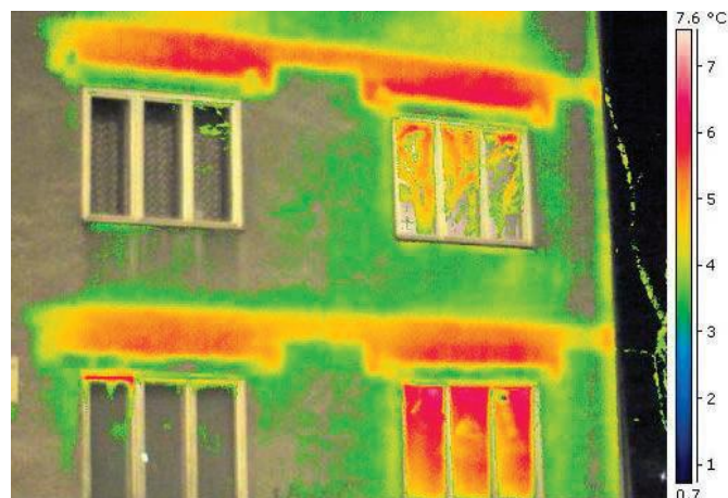
Slika 16. Termografska slika koja prikazuje postojanje toplinskih mostova uzrokovanih upotrebom različitih materijala [1]
