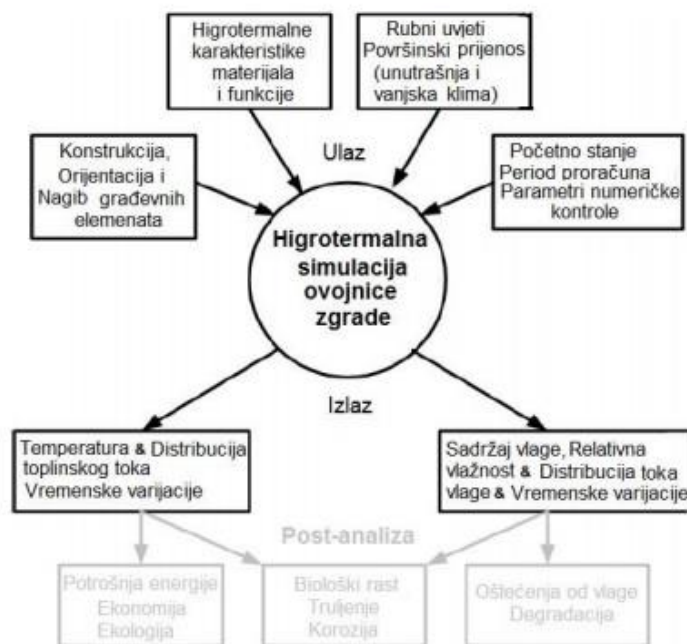
Slika 16. Dijagram toka za provođenje dinamičkih higrotermalnih simulacija ovojnice zgrade [27]
