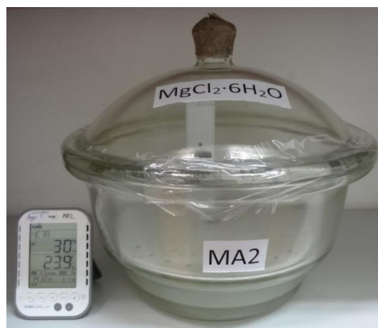
Slika 24 Vanjski termohigrometar s transponderom unutar eksikatora
