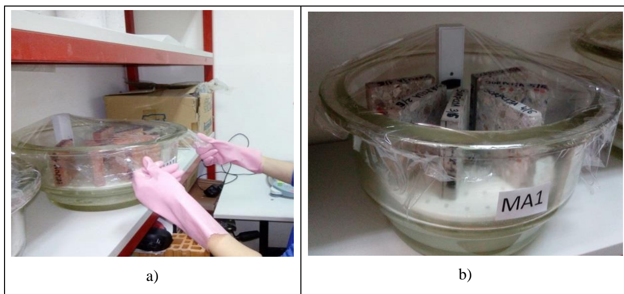
Slika 23. Eksikator tijekom vaganja uzoraka: a) postavljanje prozirne folije preko posude eksikatora; b) uzorci unutar eksikatora zaštićeni prozirnima folijom tijekom vaganja
