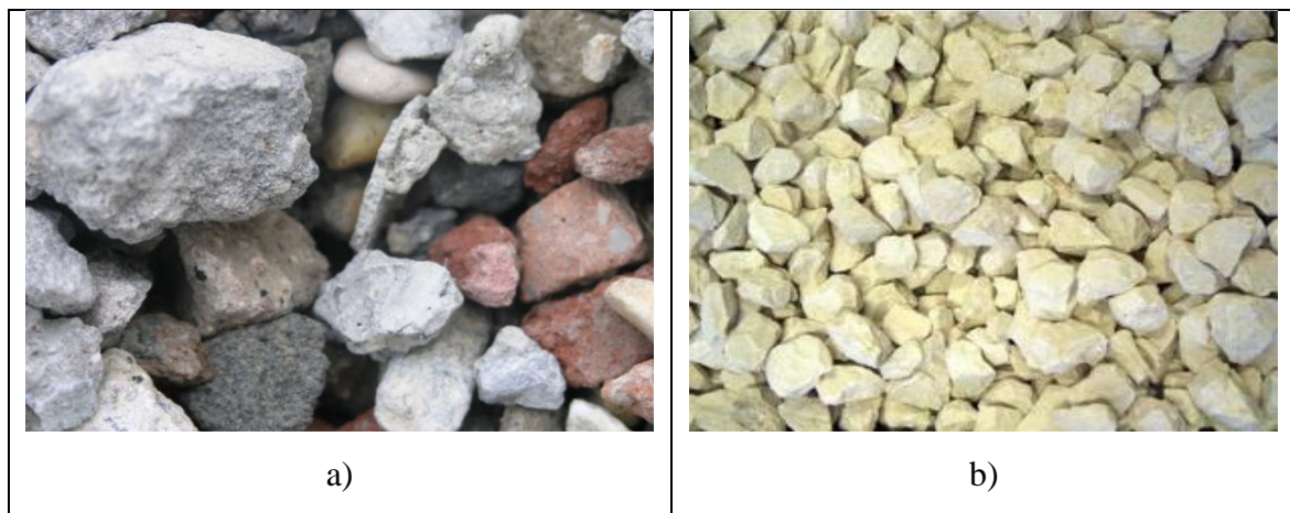
Slika 5. Izgled agregata: a) reciklirani agregat b) prirodni drobljeni agregat [5]
