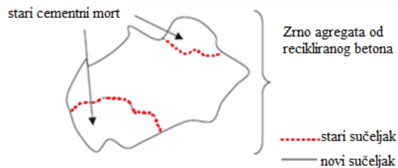
Slika 7. Zona sučeljka u betonskoj mješavini [16]
