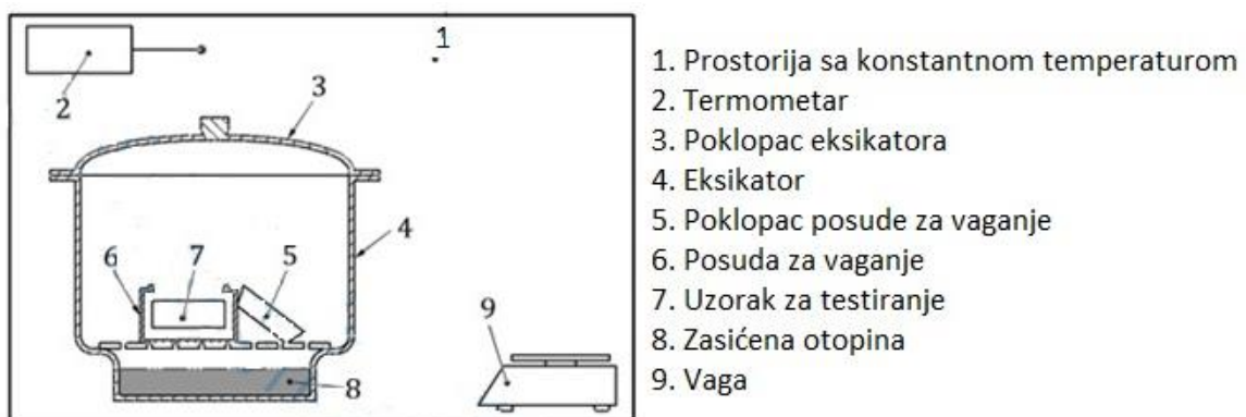
Slika 19. Aparatura prema HRN EN ISO 12571 [33]
