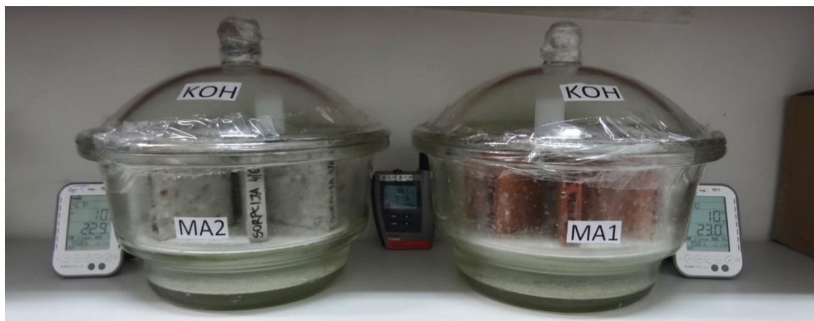
Slika 27. Eksikator za vrijeme postizanja relativne vlažnosti; Lijevo: uzorci betona s recikliranim betonom; Desno: uzorci betona s recikliranom opekom
