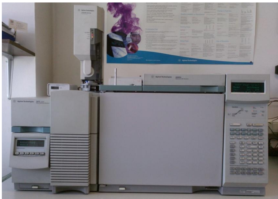
Slika 5. Agilent Technologies plinski kromatograf 6890N s 5975i masenim spektrometrom (vlastita fotografija)
