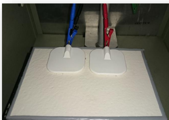
Slika 19. Komercijalne elektrode TENS na premazanom metalu
