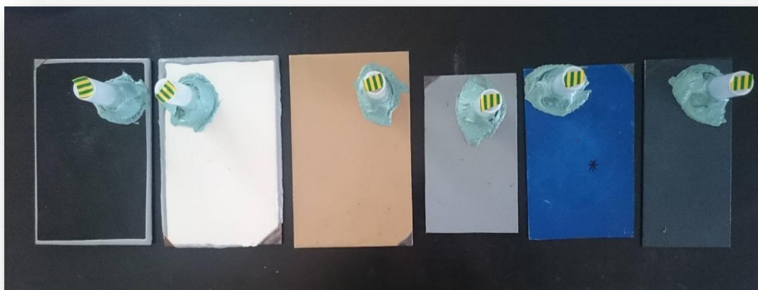
Slika 14. Uzorci korišteni za EIS mjerenja zaštitnih svojstava premaza velikom i malom ćelijom
