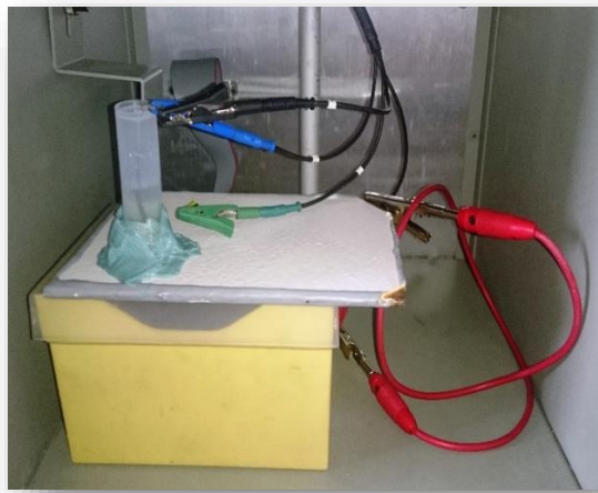
Slika 17. Mala elektrokemijska ćelija na premazanom metalu unutar Faradayjevog kaveza
