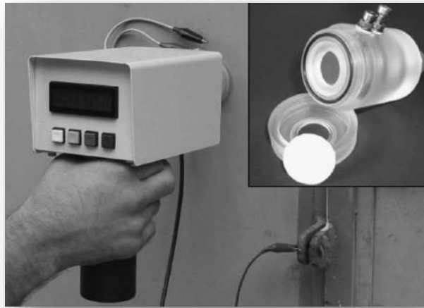
Slika 13. Uređaj za in situ mjerenje impedancije premaza [16]
