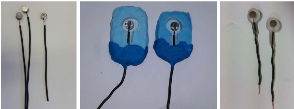
Slika 3.1. Izrada radnih elektroda – zalijevanje elektroda u epoksidnu smolu
