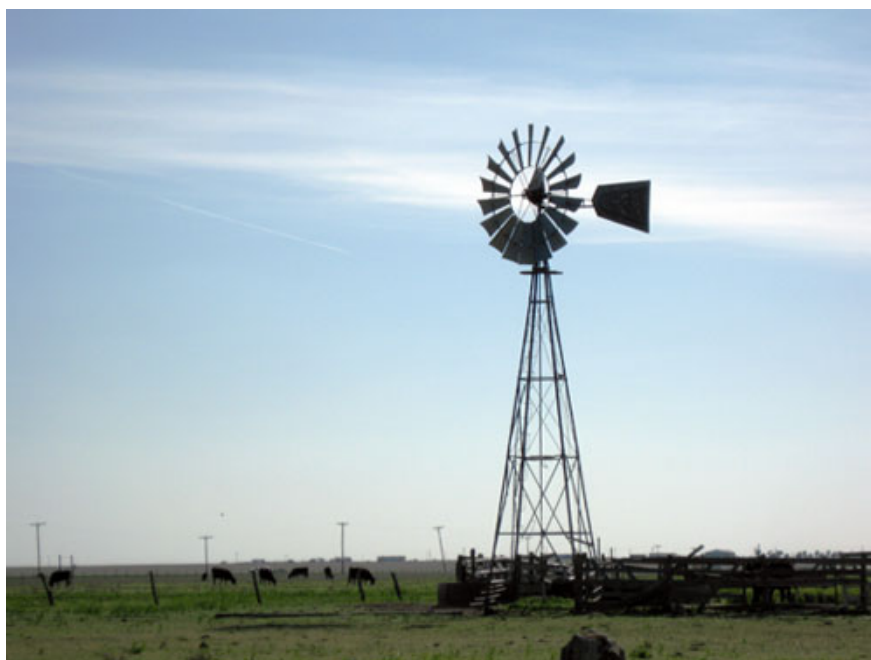
Slika 11: Primjer američke vjetroturbine na više katova [1]
