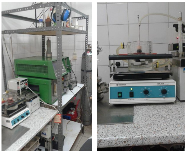
Slika 6. Aparatura za postupak sinteze nanočestica i imobilizacije enzima, uz konstantan dotok zraka
