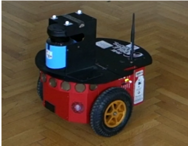
Slika 3.6: Slika robota Pioneer P3-DX u laboratoriju
