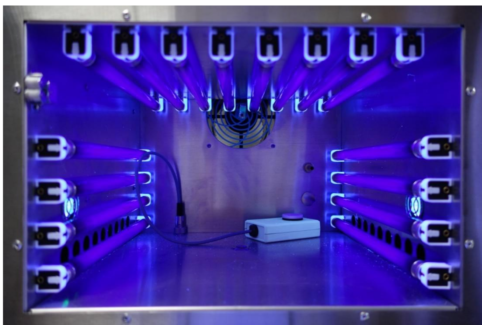
Slika 25. Unutrašnjost fotokemijskog reaktora Luzchem .
