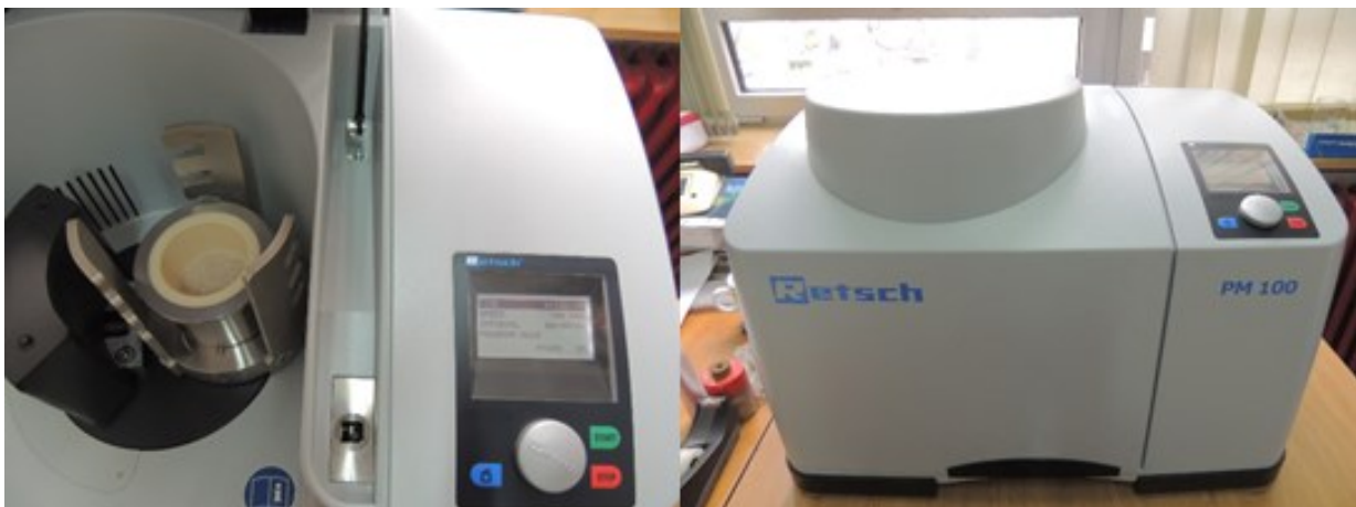
Slika 10. Usitnjavanje ljusaka jajeta u planetarnom kugličnom mlinu
