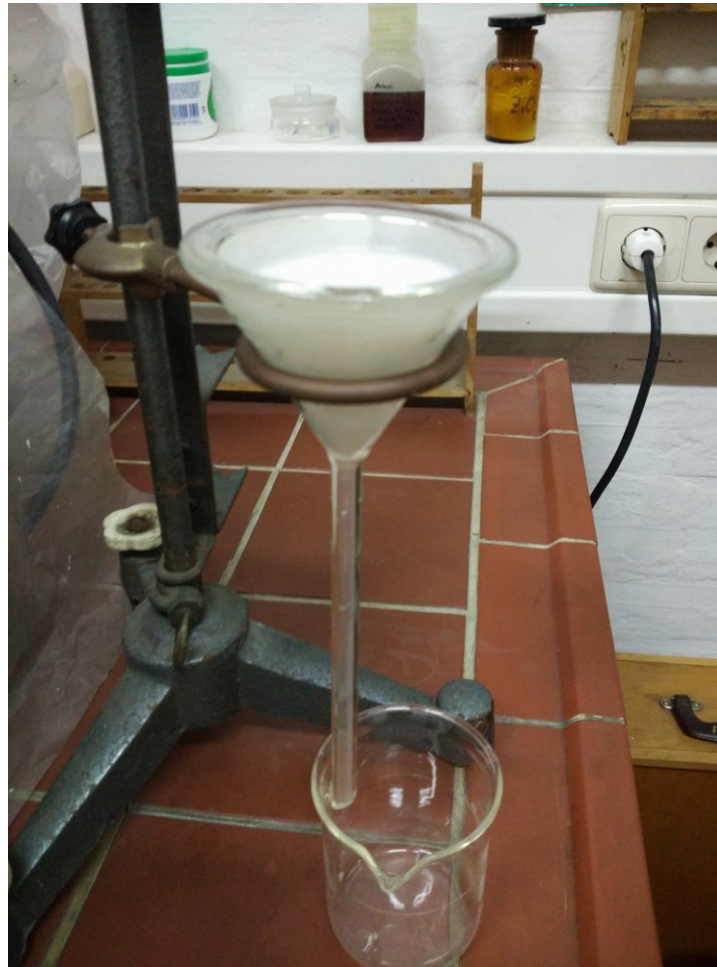
Slika 14. Filtriranje precipitata nakon precipitacijskog taloženja hidroksiapatita
