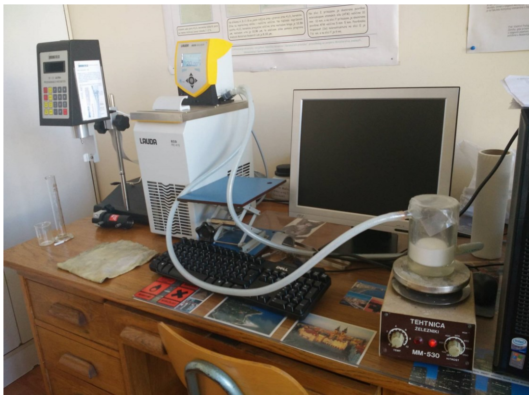
Slika 13. Reaktor za hidrolizu kalcijevog hidroksida, \text{Ca}(\text{OH})_2
