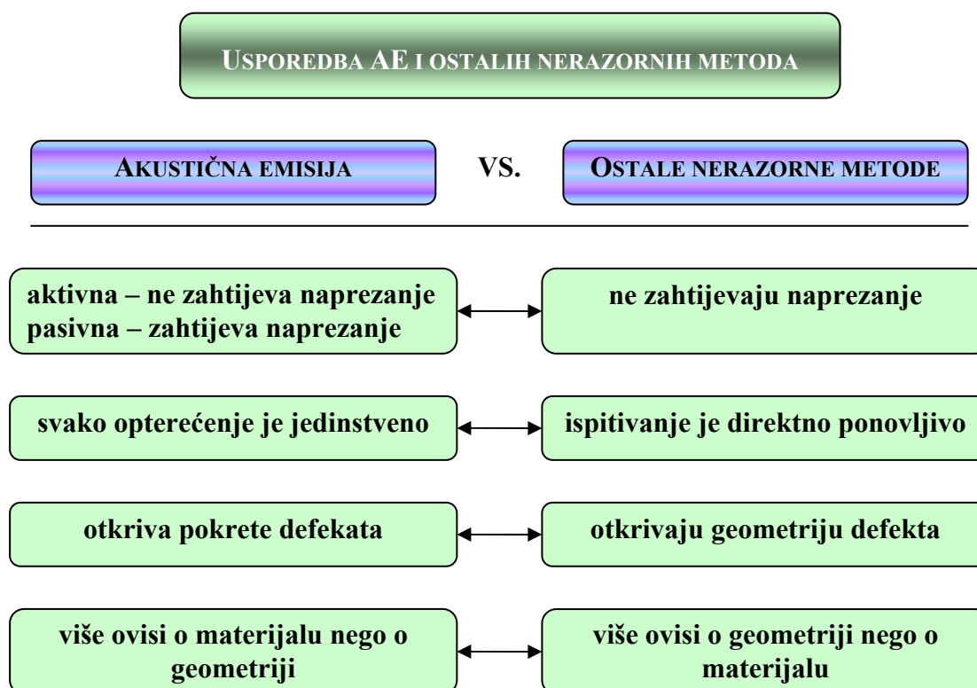
Slika 3-10. Usporedba AE i ostalih nerazornih metoda
