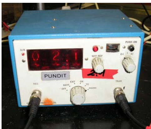
Slika 6-16. Uređaj za ispitivanje brzine prolaska zvuka
