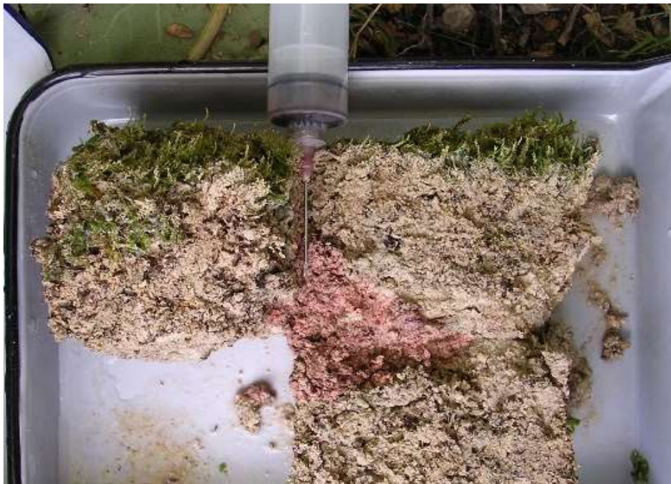
Slika 4. Trag kongo crvenila u sedrenom bloku nakon 45 minuta. Trag ukazuje na brzinu prodora vode kroz plitki sedreni intersticij. Igla brizgalice je duga 37 mm, smjer površinskog toka je udesno.
