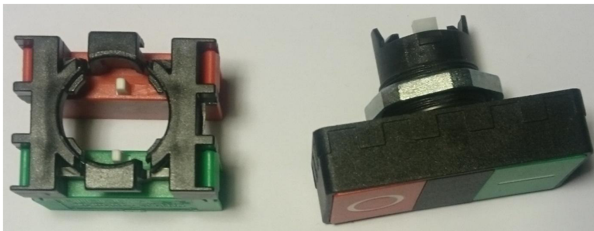
Slika 45. Kontaktne elemente mirne (crveni) i radne (zeleni) s lijeve strane i dvostuko tipkalo s desne strane
